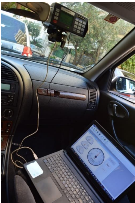
Εικόνα 4.21 Η διάταξη του VC4000RG και του laptop με το οποίο ήταν συνεχώς συνδεδεμένο
