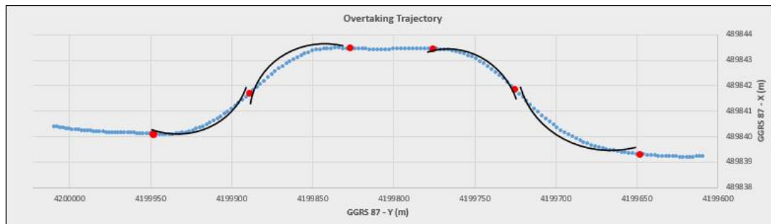
Σχήμα 4.12 Η οριζοντιογραφία μιας προσπέρασης υπό τη θεώρηση ότι κάθε φάση αποτελείται από ένα κυκλικό τόξο.
