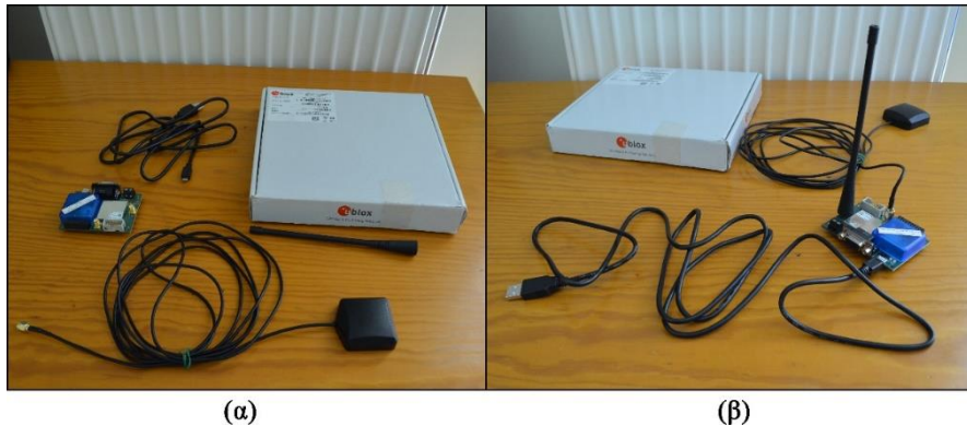
Εικόνα 4.11 Η συσκευή u-blox C94-M8P-3.
