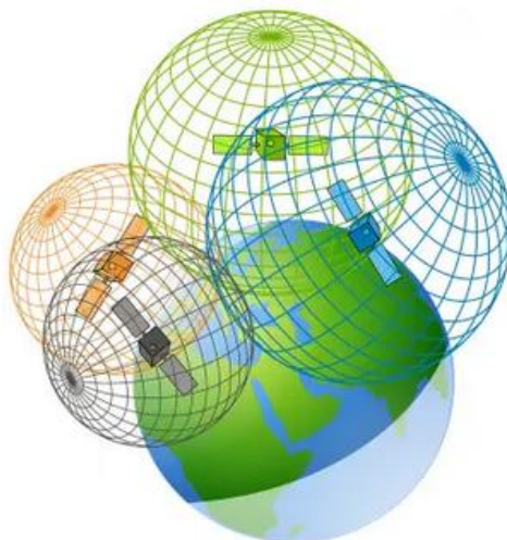
Σχήμα 3.24 Το σημείο τομής τεσσάρων σφαιρών στο χώρο αντιπροσωπεύει το σημείο στο οποίο βρίσκεται ο δέκτης GNSS (GISGeography, 2021).
