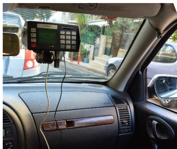
Εικόνα 4.20 Τοποθέτηση του VC4000RG στο εσωτερικό του ανεμοθώρακα.
