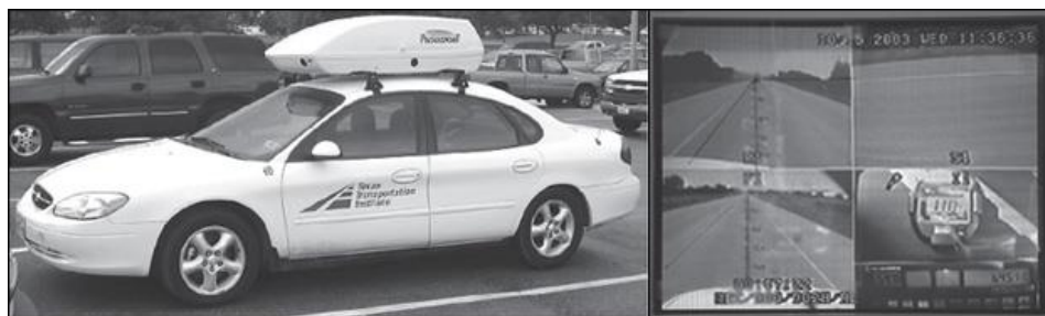
Εικόνα 2.4 Το όχημα καταγραφής με τις κάμερες τοποθετημένες μέσα στην ειδική βαλίτσα οροφής (αριστερά) και το οπτικό τους πεδίο (δεξιά) (Carlson et al., 2006).
