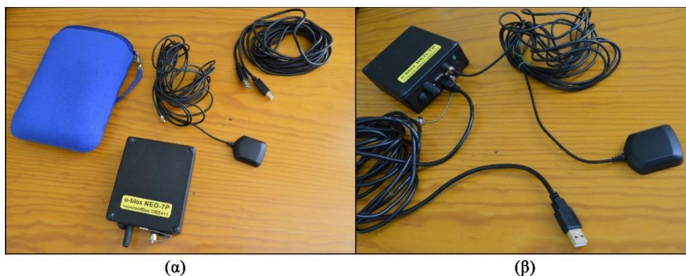
Εικόνα 4.10 Η συσκευή u-blox NEO-7P.
