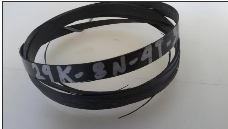
Σχήμα 6.28 Αστοχία δοκιμών της σειράς C24K_100_10_2_F8_T4
