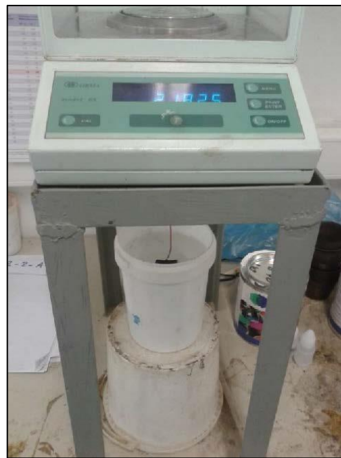
Σχήμα 4.2 Μέτρηση της μάζας του δοκιμίου στο νερό.
