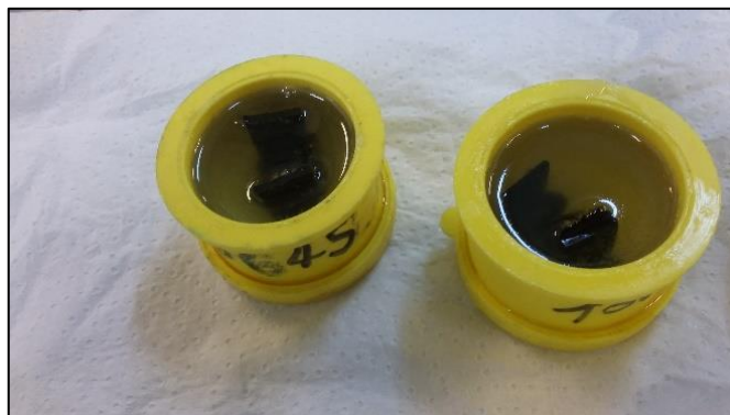
Σχήμα 4.10 Εγκιβωτισμός δοκιμίων από σύνθετο υλικό σε εποξική ρητίνη. Σε κάθε καλούπι έχουν τοποθετηθεί 2 δοκίμια για οικονομία στα υλικά και στο χρόνο λείανσης.
