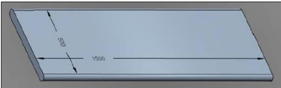
Σχήμα 2.7 Διαστάσεις και μορφή επίπεδου καλουπιού.
