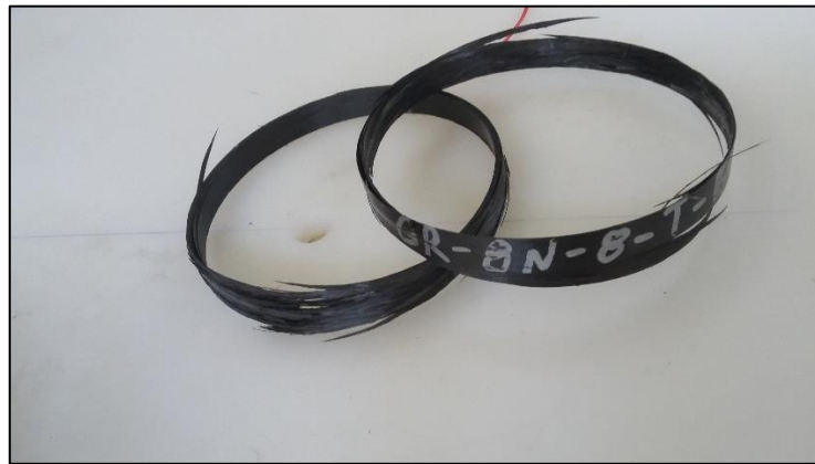
Σχήμα 6.27 Αστοχία δοκιμών της σειράς GR_100_10_2_F8_T8
