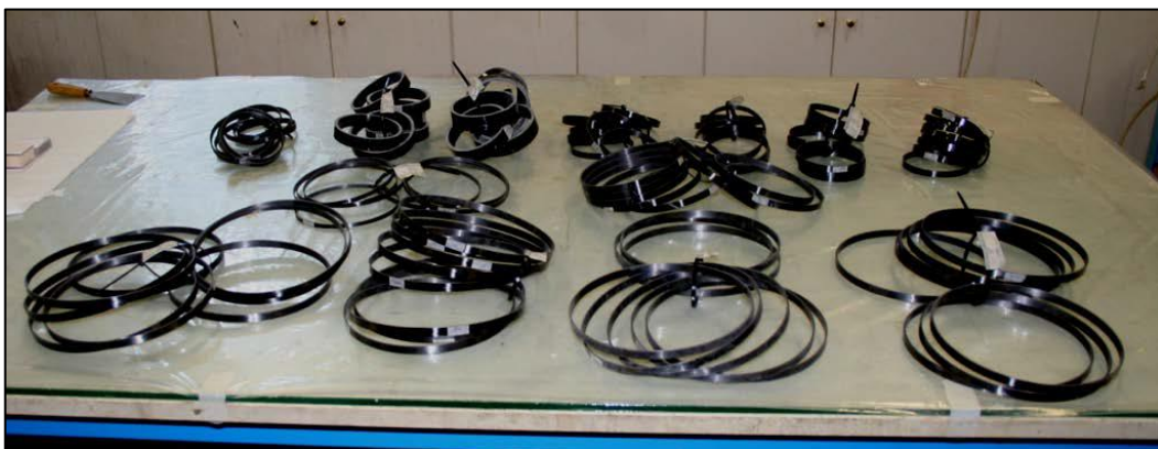
Σχήμα 6.4 Γενική όψη των δοκιμίων ταξινομημένων σε ομάδες με βάση τα γεωμετρικά και κατασκευαστικά τους χαρακτηριστικά.
