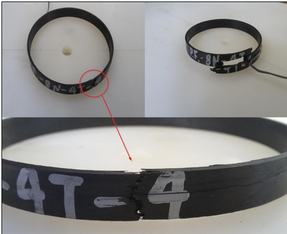
Σχήμα 6.26 Αστοχία δοκιμίων της σειράς PF_100_10_2_F8_T8
