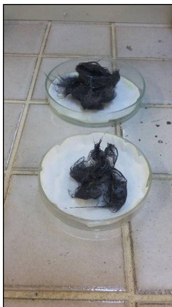
Σχήμα 4.8 «Μαλλί» από ίνες άνθρακα πάνω στο φίλτρο διήθησης, έπειτα από αποβολή της υγρασίας.
