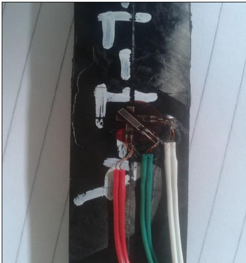
Σχήμα 5.7 Απεικόνιση ροζέτας τοποθετημένης στο δοκίμιο με γωνία περιέλιξης ινών \pm 55^\circ .
