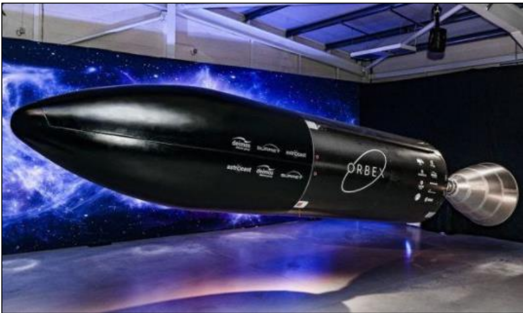
Σχήμα 1.10 Prime Rocket, της εταιρίας Orbex κατασκευασμένος με τη μέθοδο περιέλιξης ινών.
