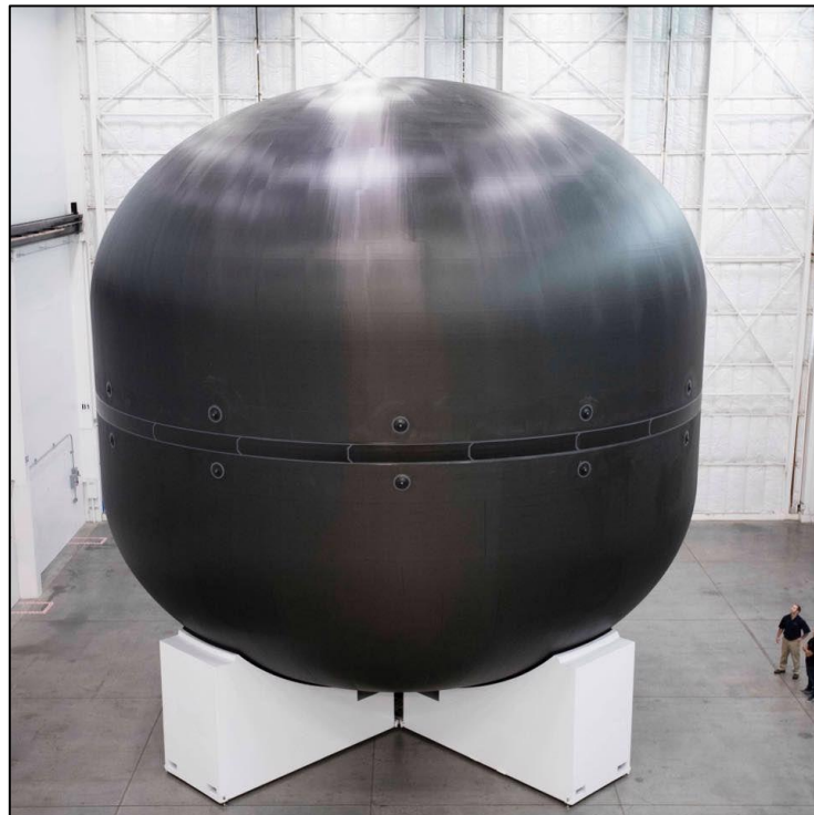
Σχήμα 1.12 Δεξαμενή αποθήκευσης υγρού οξυγόνου από σύνθετο υλικό με carbon fibers
