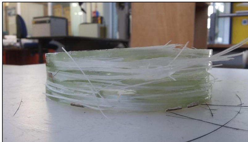
Σχήμα 6.16 Τυπική μορφή αστοχίας δοκιμίου από ίνες γυαλιού.
