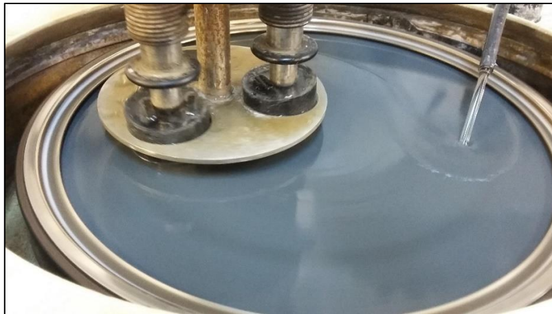
Σχήμα 4.11 Λείανση της επιφάνειας δύο χυτών με σύνθετα υλικά εγκιβωτισμένα, στον εργαστηριακό λειαντήρα.
