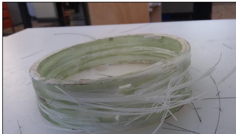
Σχήμα 6.17 Τυπική μορφή αστοχίας δοκιμίου από ίνες γυαλιού.
