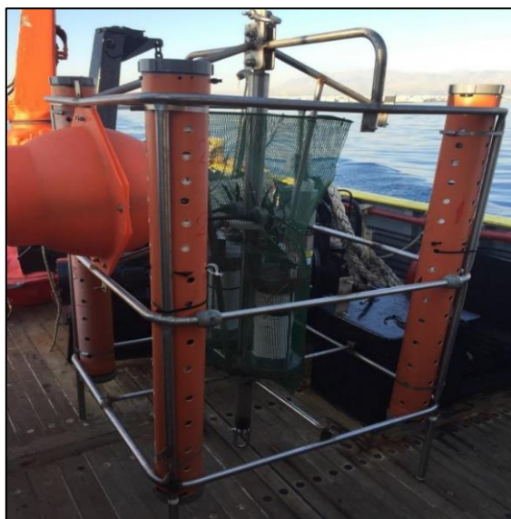
Σχήμα 3.1 Απεικόνιση της διάταξης πόντισης με τις ξεχωριστές ομάδες δοκιμίων, οι οποίες βρίσκονται κάθε μία μέσα σε έναν από τους κατακόρυφους κυλίνδρους χρώματος πορτοκαλί.
