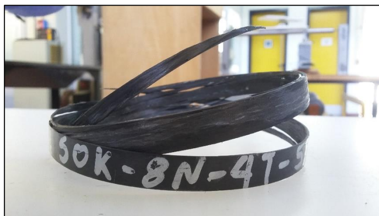
Σχήμα 6.29 Αστοχία δοκιμών της σειράς C50K_100_10_2_F8_T4
