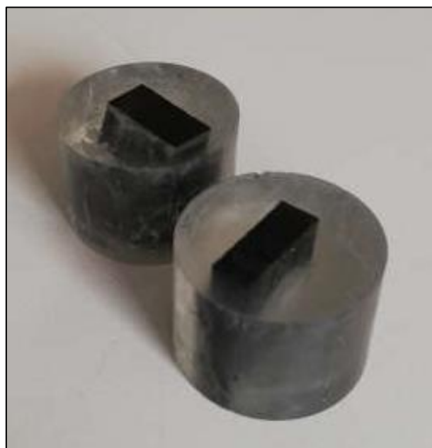
Σχήμα 4.12 Δοκίμια από σύνθετο υλικό εγκιβωτισμένα σε ρητίνη μετά από κατεργασία λείανσης της επιφάνειάς τους.
