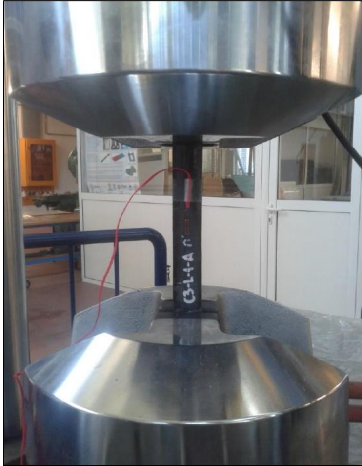
Σχήμα 5.4 Τοποθέτηση δοκιμίου στην υδραυλική μηχανή.
