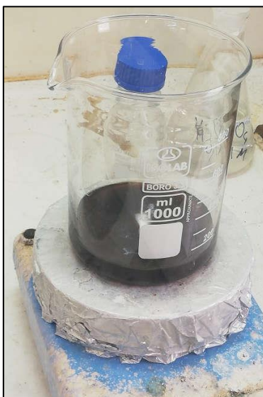
Σχήμα 4.6 Σκουρόχρωμο μείγμα που παρατηρείται όταν η ρητίνη του σύνθετου υλικού έχει διαλυθεί στο νιτρικό οξύ.
