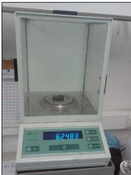
Σχήμα 4.1 Μέτρηση της μάζας του δοκιμίου στον αέρα.
