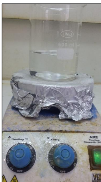
Σχήμα 4.5 Κομμάτι του σύνθετου υλικού βαπτισμένο σε νιτρικό οξύ κατά την ανάδευση και θέρμανση του.
