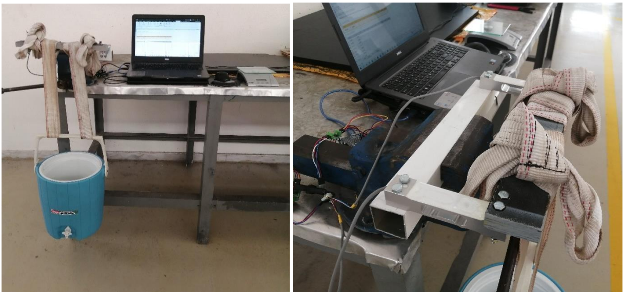
Εικόνα 5.1: Η πειραματική διάταξη για τη βαθμονόμηση και αξιολόγηση της λειτουργίας των δυναμοκυψελών
