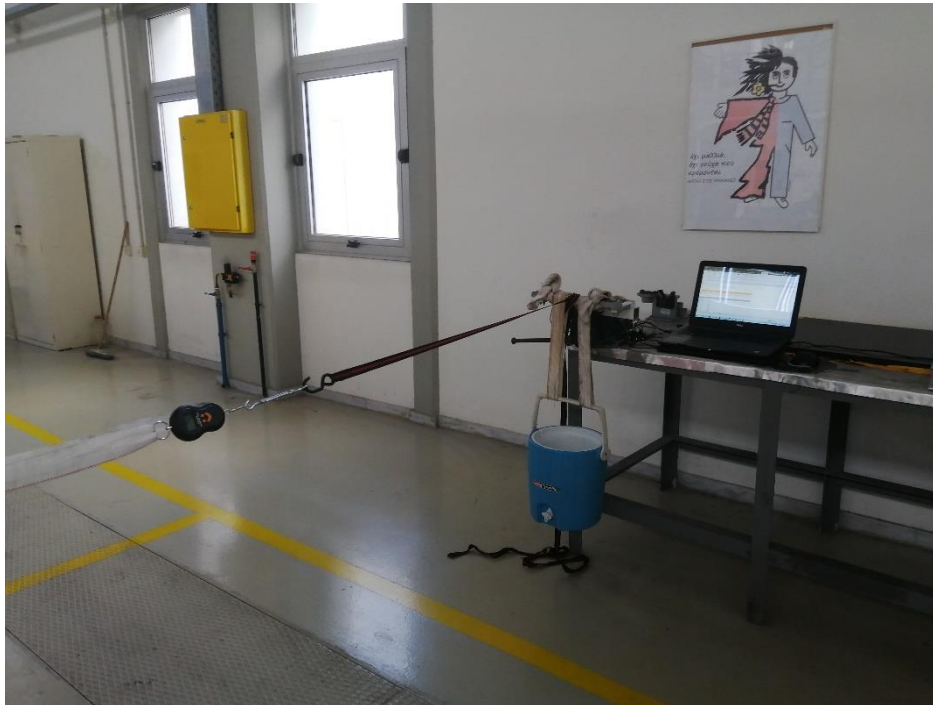
Εικόνα 5.2: Η πειραματική διάταξη αξιολόγησης της λειτουργίας των δυναμοκυψελών ενεργού οριζόντιου φορτίου
