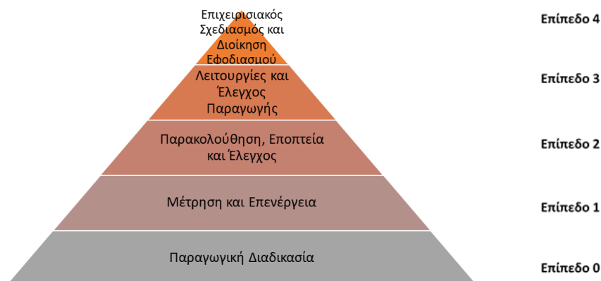
Εικόνα 1.1: Δομή σύγχρονων συστημάτων παραγωγής σύμφωνα με το πρότυπο IEC 62264 (προσαρμοσμένη από [3])
