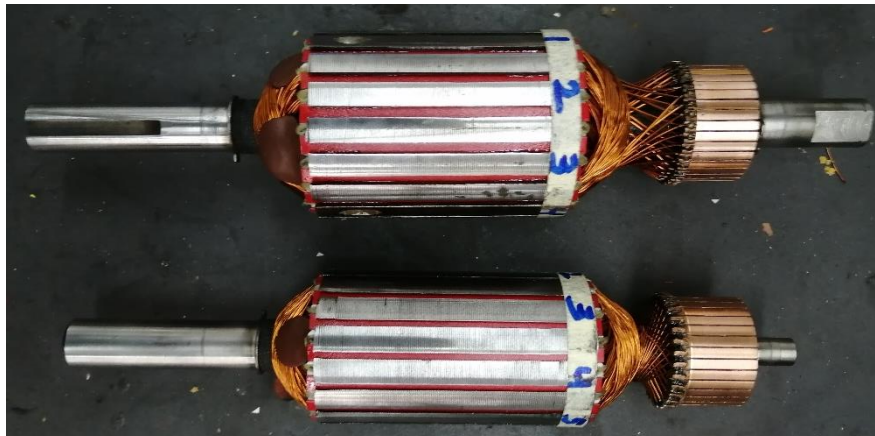
Εικόνα 6.20: Άτρακτοι κινητήρων συνεχούς ρεύματος μόνιμων μαγνητών (επάνω: από κινητήρα ισχύος 3HP και κάτω: από κινητήρα ισχύος 1HP)
