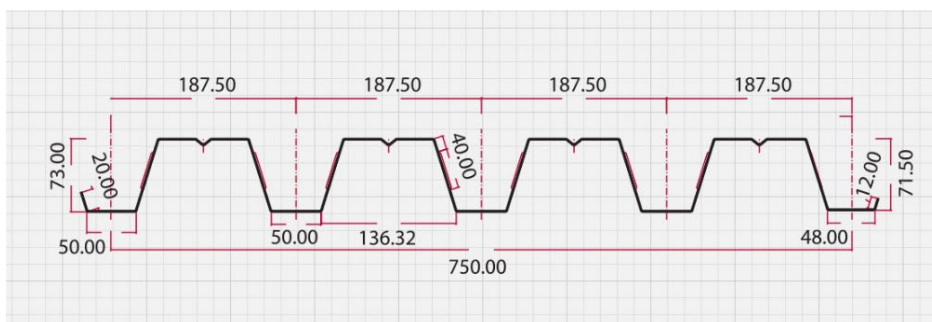
Σχήμα 1.8: Διατομή χαλυβδόφυλλου SYMDECK 73, πάχους t=0,8 \text{ mm}
