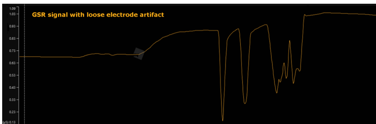
Σχήμα 3.3: Motion artifacts, αποσύνδεση ηλεκτροδίων (GSR artifacts, n.d.)
