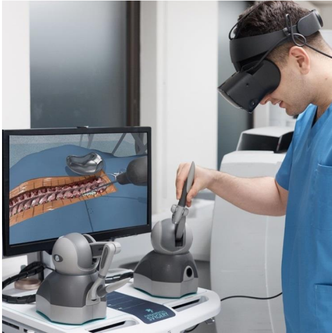
Σχήμα 11 Πλατφόρμα HapticVR-Απτικοί βραχίονες Geomagic Touch [44]
