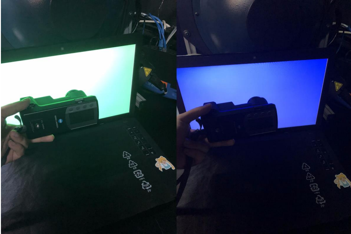
Εικόνα 4.3.5. Μέτρηση πράσινου και μπλε χρωματικού patch με το φασματόμετρο KONICA MINOLTA CL500A
