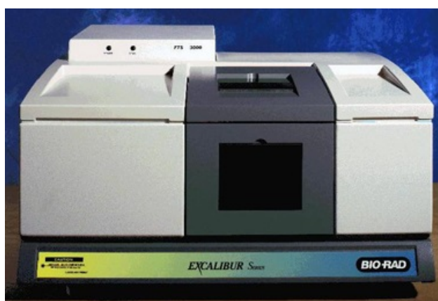
Εικόνα 2.27β Φασματοφωτόμετρο υπέρυθρου μετασχηματισμού Fourier, Biorad FTS 3000MX Excalibur Series [84]
