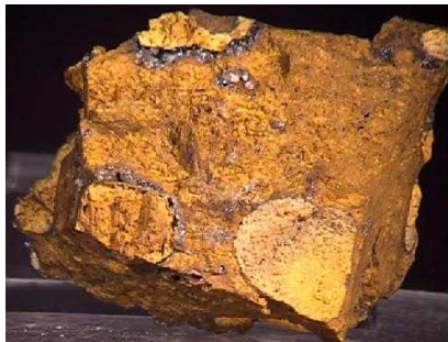
Εικόνα 1.11 Λειμωνίτης με φλέβες κερραγγυρίτη [103]
