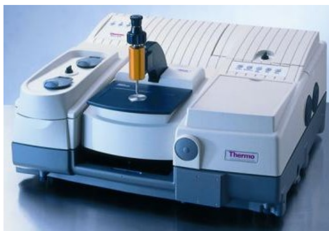
Εικόνα 1.56 Φασματοφωτόμετρο Υπερύθρου Μετασχηματισμού Fourier (FTIR), Nicolet 6700 Thermoscientific, διακριτικής ικανότητας 4\text{ cm}^{-1} , με Αποσβένουσα Ολική Ανάκλαση (ATR) [127]
