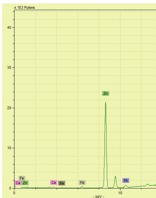
Σχήμα 2.41 Φάσμα XRF από σημείο χωρίς χρωματική εντύπωση (καμβάς) του πίνακα No 71 (Εικ. 2.24)
