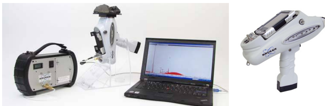
Εικόνα 1.54 Φορητή συσκευή XRF τύπου Tracer III-SD της Bruker-AXS [126]
