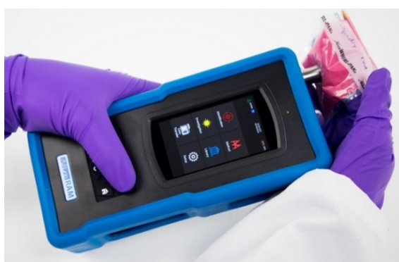
Εικόνα 2.27γ Αριστερά - Φασματοφωτόμετρο Raman, B&W Tek NanoRam® [85] Δεξιά - Φασματοφωτόμετρο micro-Raman, Renishaw Invia-Reflex [86]
