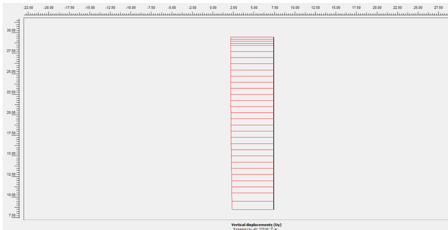
Εικόνα 59. Κατακόρυφες μετακινήσεις πασσάλων 21m με μία σειρά αγκυρίων
