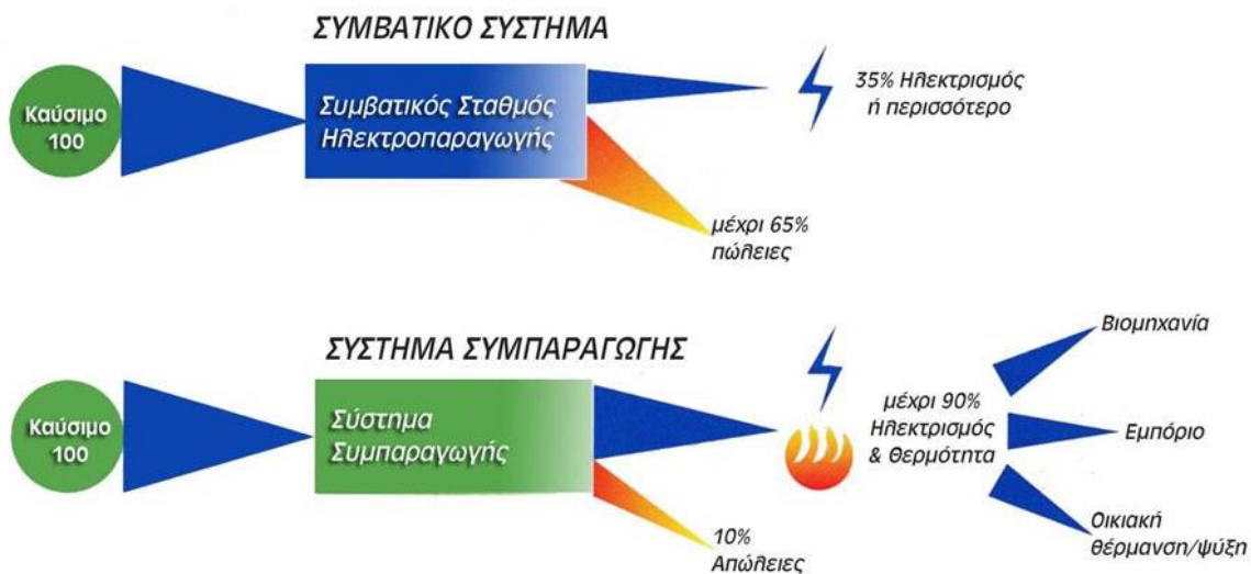
Εικόνα 1.9: Κατανομή παραγόμενης ενέργειας σε συμβατικό σύστημα ηλεκτροπαραγωγής και σε σύστημα συμπαγωγής.
