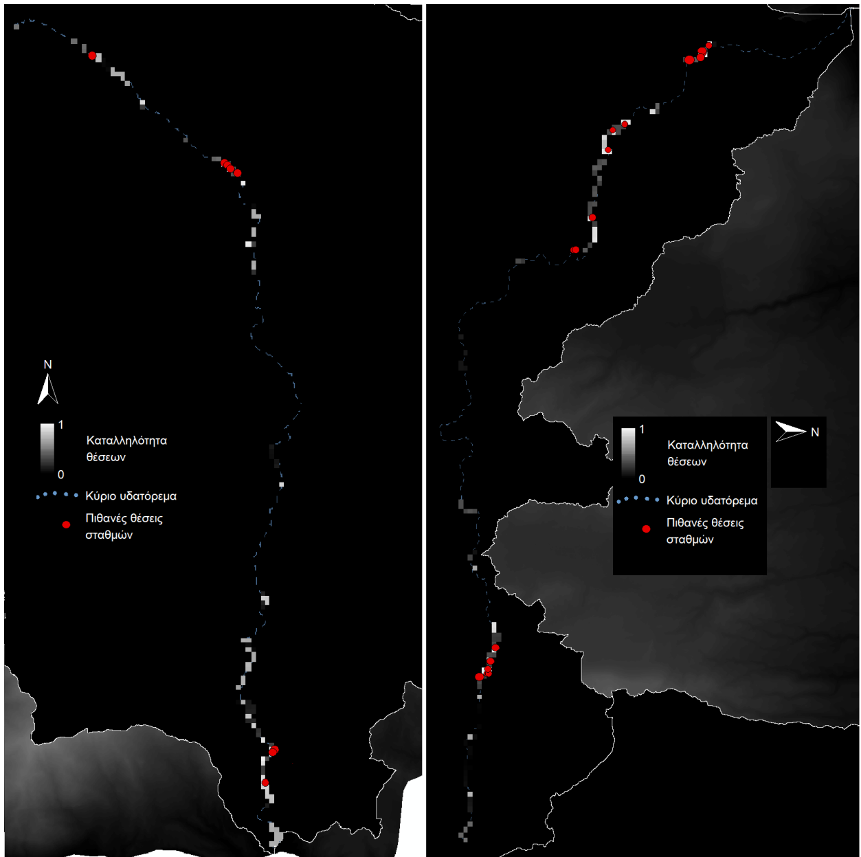
Σχήμα 5.2.3.2: Χάρτης καταλληλότητας χωροθέτησης υδρομετρικού σταθμού για την λεκάνη απορροής του Πλατύ (αριστερά) και του Πρασσανού (δεξιά).
