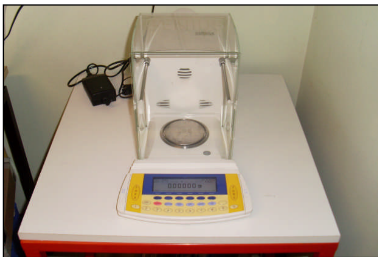
Εικόνα 2.17: Ο ζυγός, ακρίβειας 5 δεκαδικών ψηφίων, με τον οποίο γίνεται η ακριβής μέτρηση των υποστρωμάτων πριν και μετά την διαδικασία χημικής απόθεσης.
