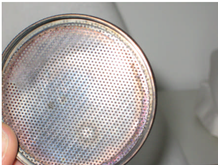
Εικόνα 2.4: Το πλέγμα με τις τρύπες του καταιωνιστήρα
