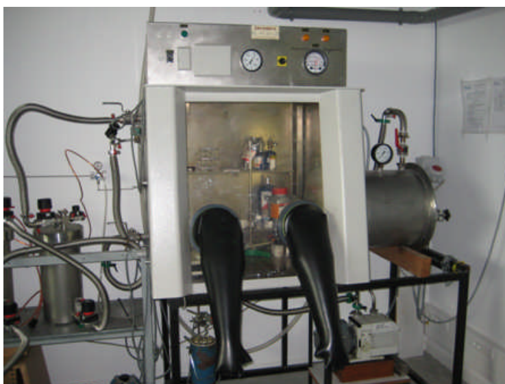
Εικόνα 2.18: Το glovebox όπου γίνεται η φόρτιση της πρόδρομης ένωσης στον εξαχνωτήρα
