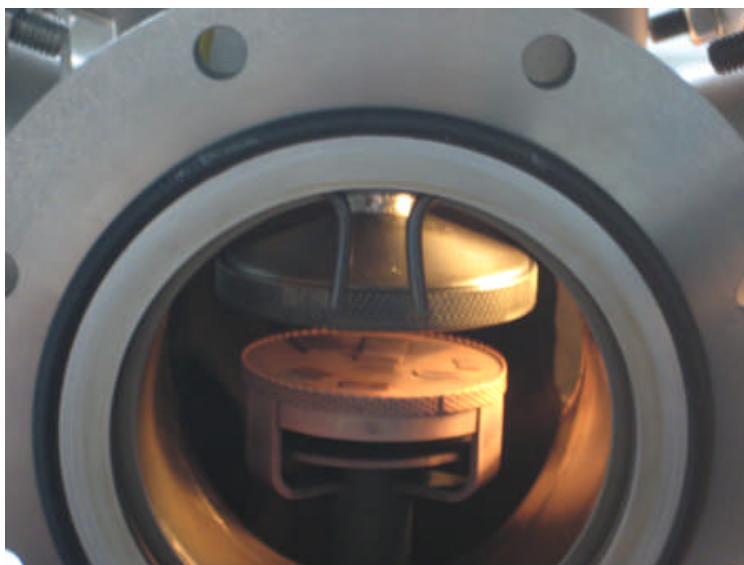
Εικόνα 2.3: Το εσωτερικό του αντιδραστήρα, κάτω ο φορέας υποστρωμάτων και πάνω ο καταιωνιστήρας
