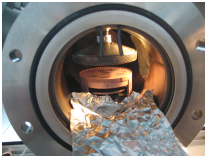
Εικόνα 2.21: Τοποθέτηση φύλλου αλουμινίου για κάλυψη του κενού μεταξύ φορέα και εισόδου του αντιδραστήρα, για να αποφεύγεται το χάσιμο των επικαλυμμένων υποστρωμάτων
