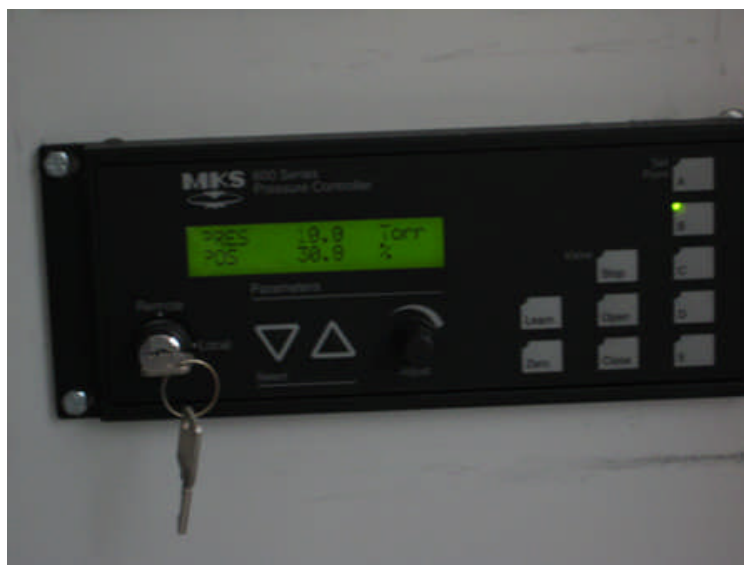
Εικόνα 2.29: Η πίεση εντός του αντιδραστήρα (10 torr) και η θέση της κεντρικής βαλβίδας (30,8% ανοιχτή), ώστε να επιτυγχάνεται αυτή η πίεση με τις δεδομένες ροές
