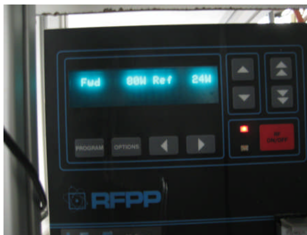
Εικόνα 2.26: Στο πάνελ του πλάσματος το κόκκινο κουμπί ξεκινάει τη λειτουργία του. Η ένδειξη των 80W αναφέρεται στην ενέργεια που έχει τεθεί, ενώ η ένδειξη των 24W στην ενέργεια που ακτινοβολεί.
