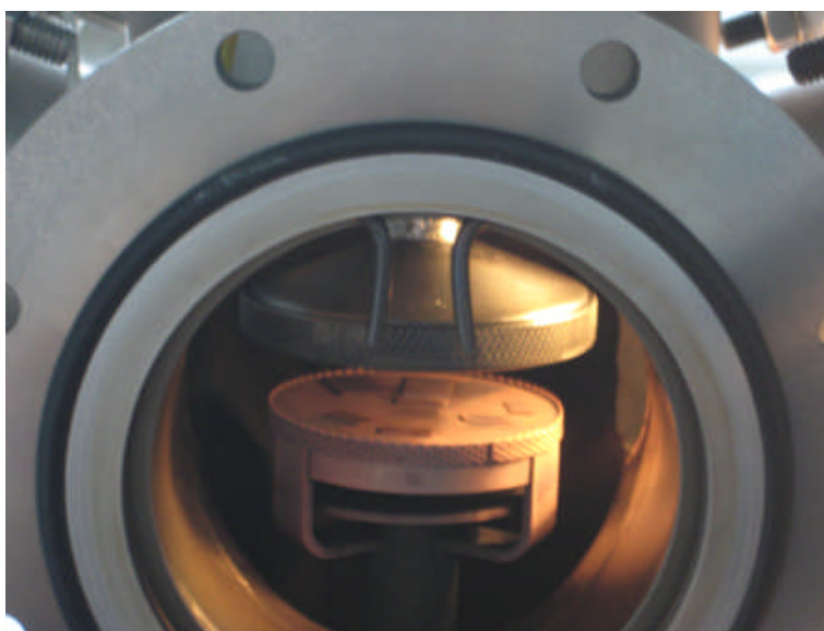
Εικόνα 2.13: Το μπροστινό τμήμα του αντιδραστήρα έχει αφαιρεθεί για το άνοιγμά του. Διακρίνονται οι υποδοχές για τα μπουλόνια και η μαύρη πλαστική φλάντζα που εξασφαλίζει την κατάλληλη επαφή κατά το κλείσιμο
