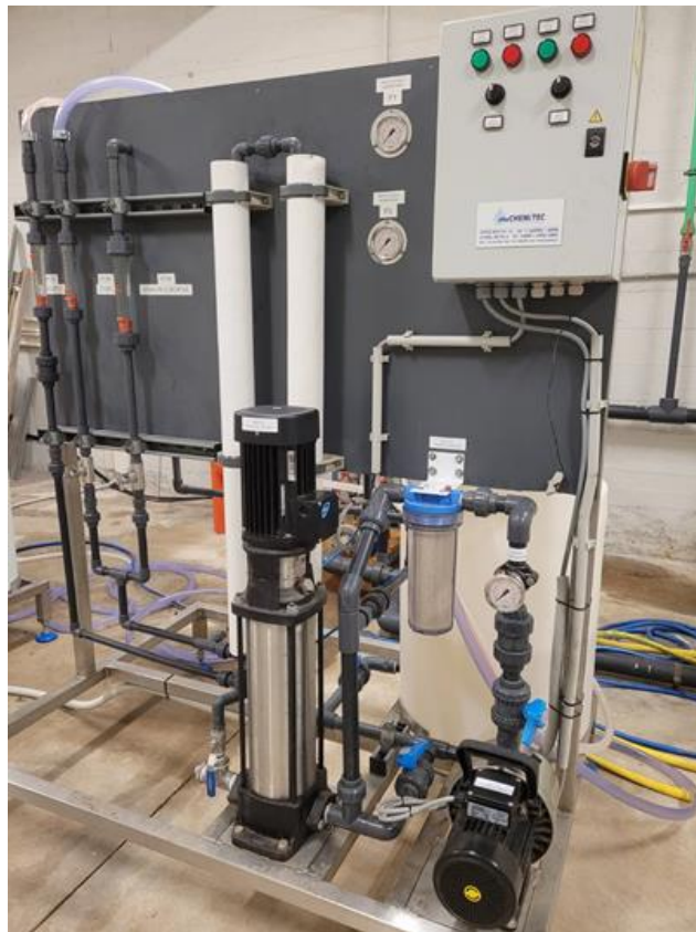
Εικόνα 3.1: Διάταξη μεμβράνης νανοδιήθησης που χρησιμοποιήθηκε στο εργαστήριο
