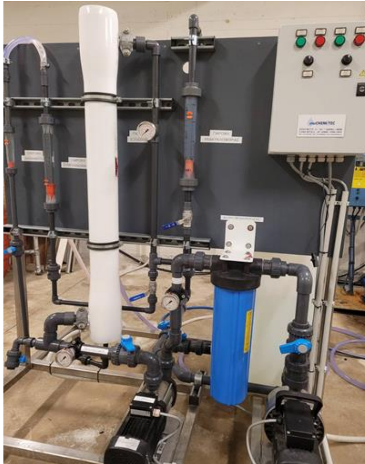
Εικόνα 3.2: Διάταξη μεμβράνης αντίστροφης ώσμωσης που χρησιμοποιήθηκε στο εργαστήριο
