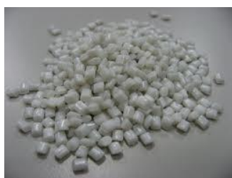
Εικόνα 13 i) Πέλετες από πολυεστέρα ii) Εξώθηση σε ίνες iii) Νήμα από πολυεστέρα [Πηγή: Σταμέλος, 2019]
