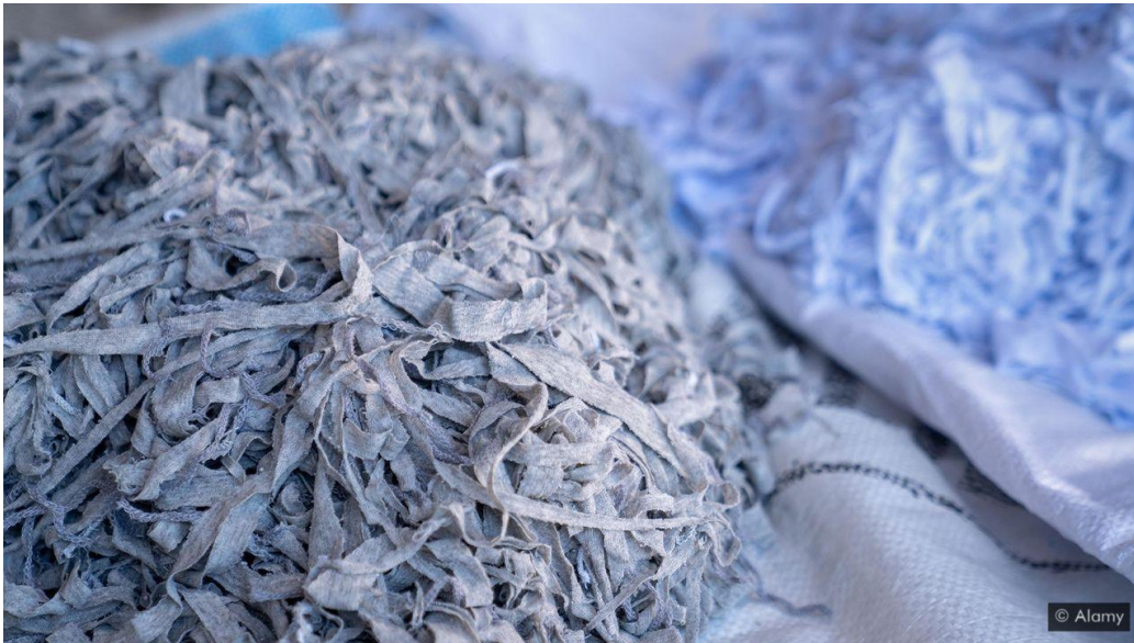
Εικόνα 12 Η διαδικασία τεμαχισμού που χρησιμοποιείται στη μηχανική μέθοδο επεξεργασίας, οδηγεί σε μικρότερες, πιο αδύναμες ίνες που δεν μπορούν να χρησιμοποιηθούν αυτούσιες για να φτιάξουν ρούχα [Πηγή: BBC Future]
