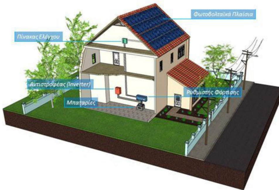
Εικόνα 3.13: Τα επιμέρους εξαρτήματα ενός φ/β συστήματος [3.17]
