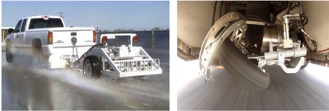
Εικόνα 2.4: Δοκιμή Ελαστικού σε Εξωτερικό Χώρο με Ελαστικό Προσδεμένο σε Ρυμουλκούμενο Όχημα
