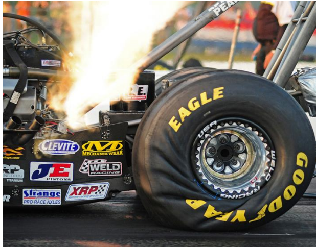
Εικόνα 1.2: Οπτικοποίηση Λόγου Ολίσθησης από Αγώνες Επιτάχυνσης (Drag Race)
