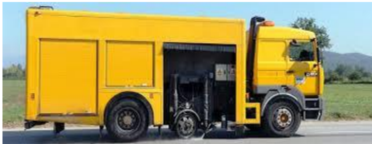
Εικόνα 2.5: Δοκιμή Ελαστικού σε Εξωτερικό Χώρο με Χρήση Ειδικά Διαμορφωμένου Φορτηγού Οχήματος
