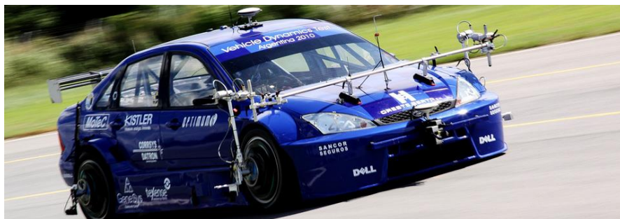
Εικόνα 2.6: Καινοτόμη Διάταξη Δοκιμής Ελαστικών σε Εξωτερικό Χώρο
