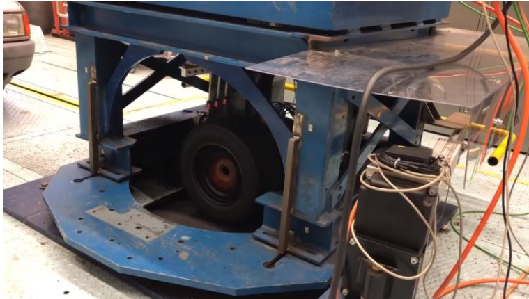
Εικόνα 2.3: Πύργος Μετρήσεων (Tire Measurement Tower)
