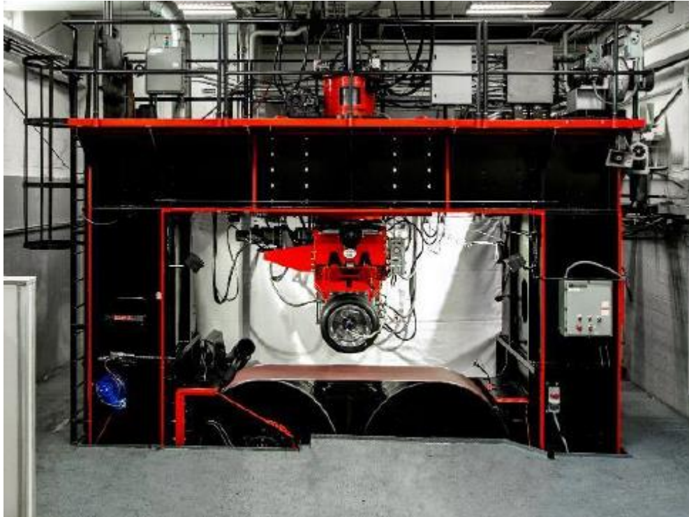
Εικόνα 2.1: Διάταξη Επίπεδης Τροχιάς (Flat Plank)
