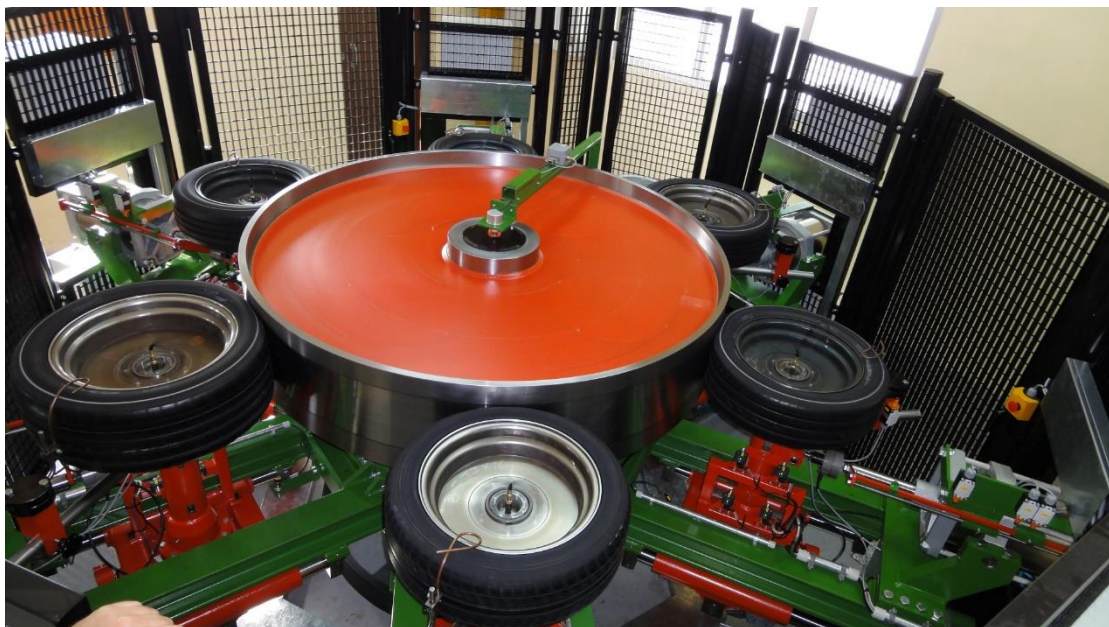
Εικόνα 2.2: Διάταξη Επίπεδης Τροχιάς (Flat Plank) με Επιφάνεια σε Μορφή Τυμπάνου
