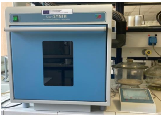
Εικόνα 11 : συσκευή μικροκυμάτων Milestone Start Synth Microwave
