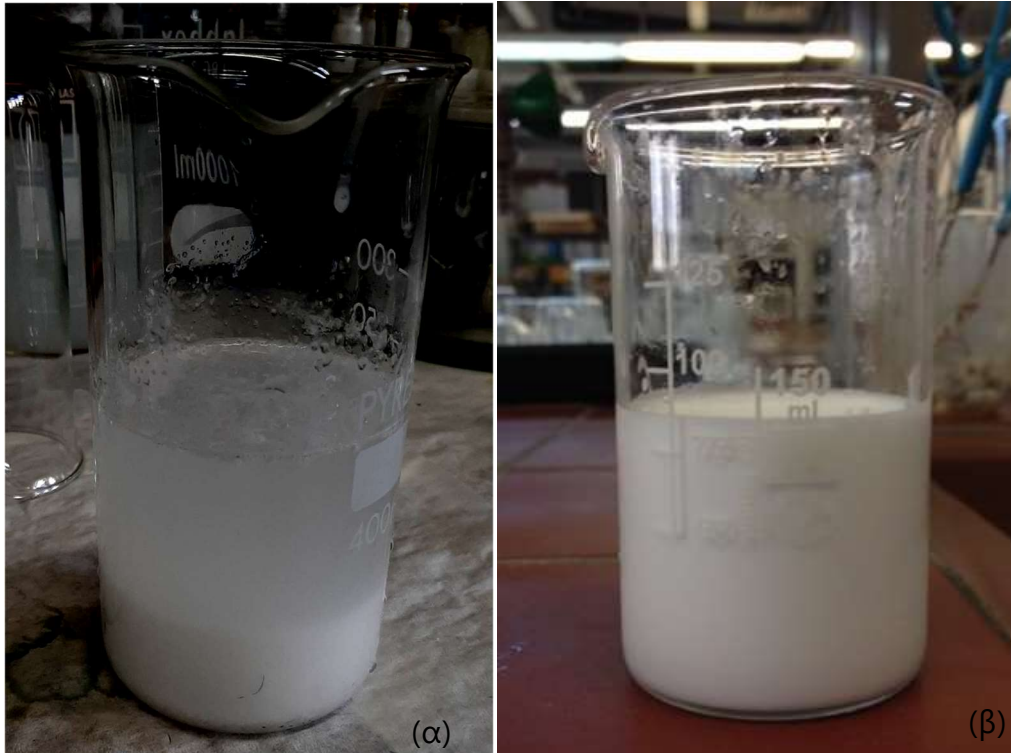
Εικόνα 5.1 α) Μη επιτυχής γαλακτωματοποίηση β) Επιτυχημένη γαλακτωματοποίηση
