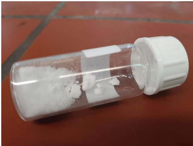
Εικόνα 6.1 Συσσωματωμένο πολυμερικό υλικό από δοκιμή προκρυστάλλωσης στους 100°C
