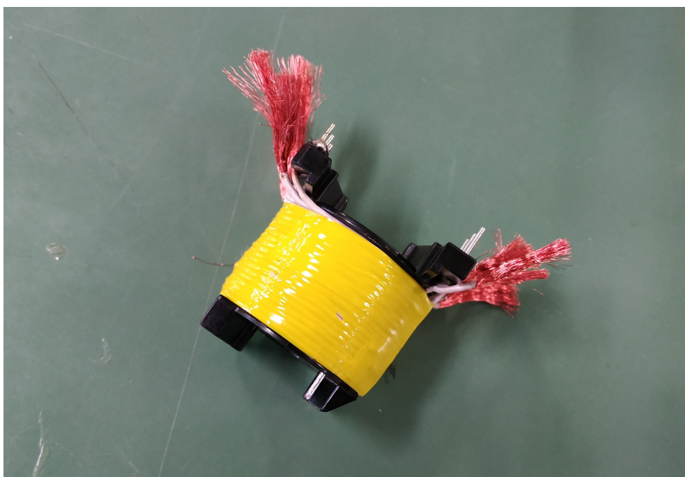
Σχήμα 5.13: Απολήξεις τυλιγμάτων με μόνωση
