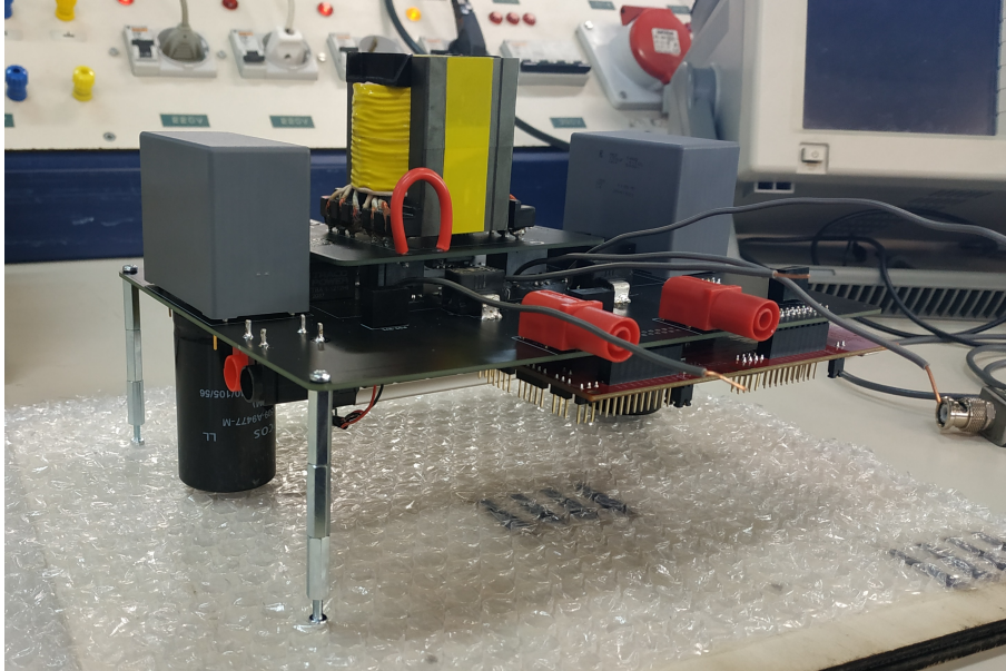
Σχήμα 7.12: Εργαστηριακή υλοποίηση νέας σχεδίασης με τον μετασχηματιστή
