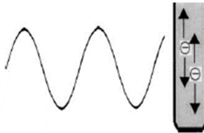
Εικόνα 4: Φορτισμένα σωματίδια διαλύματος που ακολουθούν το εφαρμοζόμενο ηλεκτρικό πεδίο. 9
