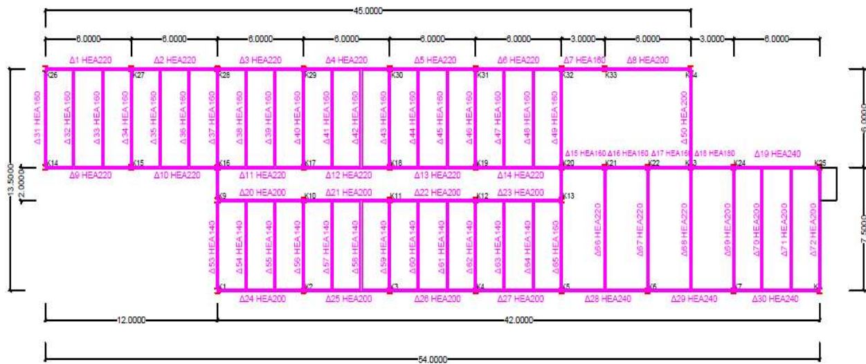
Σχήμα 2.11 ΔΟΚΟΙ ΟΡΟΦΗΣ 4 ΟΥ ΟΡΟΦΟΥ
