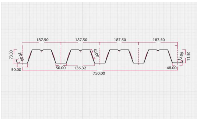
Σχήμα 2.1 Γεωμετρία χρησιμοποιούμενου χαλυβδόφυλλου
