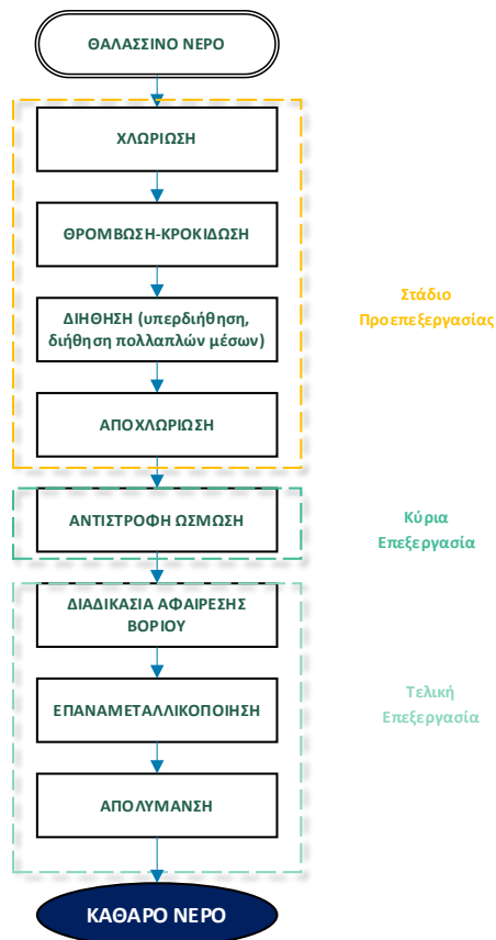
Εικόνα 1: Βασικά στάδια επεξεργασίας της μονάδας αφαλάτωσης με αντίστροφη ώσμωση.
