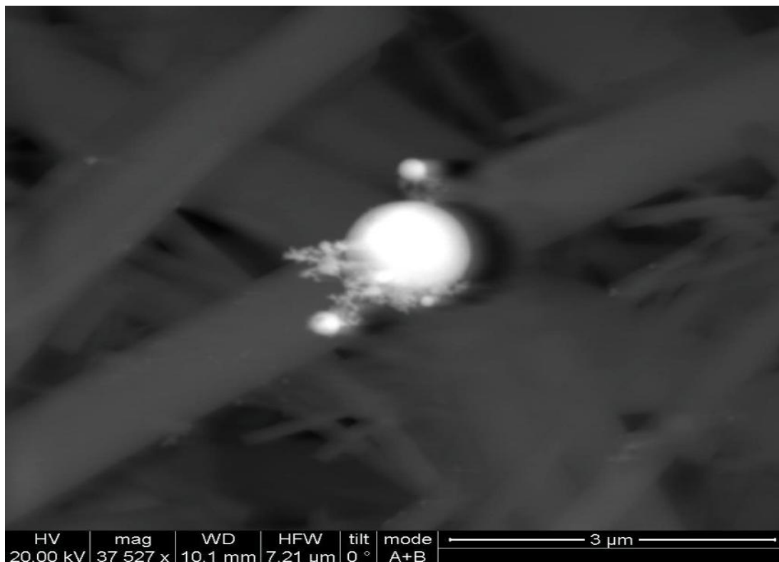
Εικόνα 28: Δείγμα 3°. Κάθετη διατομή φίλτρου μεγέθυνση ενός νανοσωματιδίου. Φράκταλς σωματιδίων χρυσού έχουν σχηματιστεί στην επιφάνεια του και μικρότερης διαμέτρου σωματίδια έχουν προσκολληθεί. 300μm περίπου βάθος από την επιφάνεια του φίλτρου.
