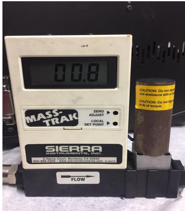
Εικόνα 19: Το ροόμετρο για την είσοδο του φέροντος αερίου
