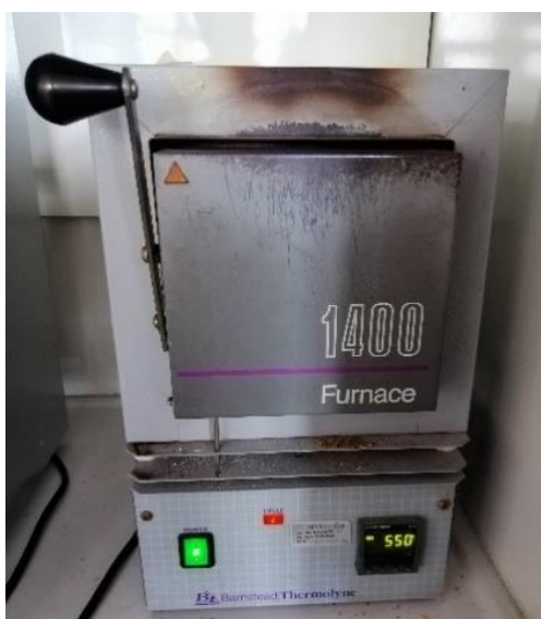
Σχήμα 5.1: Φούρνος μέτρησης πτητικών στερεών.
