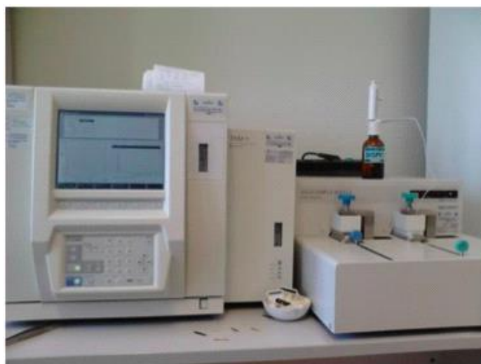
Σχήμα 5.4: Συσκευή μέτρησης TOC.
