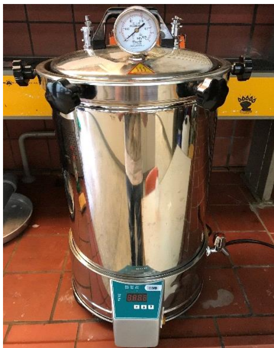
Σχήμα 5.2: Κλίβανος αποστείρωσης ISOLAB Laborgerate GmbH Autoclave.
