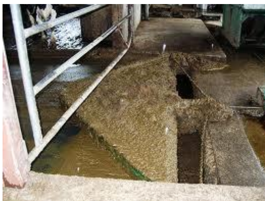
Εικ.10.6: Φωτογραφία προωθητή κόπρου ο οποίος έχει φτάσει στο τέλος του διαδρόμου και η κόπρος καταλήγει στον χάνδακα. [22]
