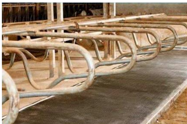
Εικ.10.3: Τύπος χωρίσματος θέσης αναπαύσεως που προβλέπεται να τοποθετηθεί στο βουστάσιο της μελέτης. Διακρίνεται το ρυθμιζόμενο κάθετο στην θέση σίδερο. [28]
