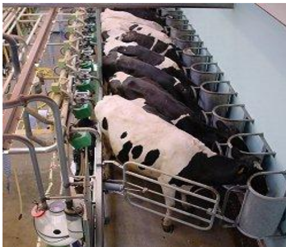
Εικ.8.3: Φωτογραφία αμελκτηρίου τύπου «ψαροκόκκαλο» [19]
