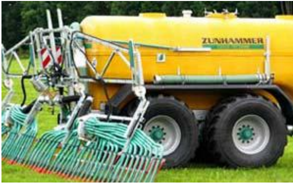
Εικ.10.7: Φωτογραφία βυτιοφόρου ειδικό για την διασπορά κόπρου στις καλλιέργειες (αριστερά) και κοπροδεξαμενή υπό κατασκευή (δεξιά) [30]
