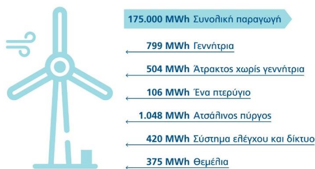
ΔΙΑΓΡΑΜΜΑ 10: ΜΕΣΗ ΕΝΕΡΓΕΙΑ ΠΟΥ ΑΠΑΙΤΕΙΤΑΙ ΓΙΑ ΤΗΝ ΚΑΤΑΣΚΕΥΗ ΤΩΝ ΕΠΙΜΕΡΟΥΣ ΤΜΗΜΑΤΩΝ ΜΙΑΣ ΑΝΕΜΟΓΕΝΝΗΤΡΙΑΣ
