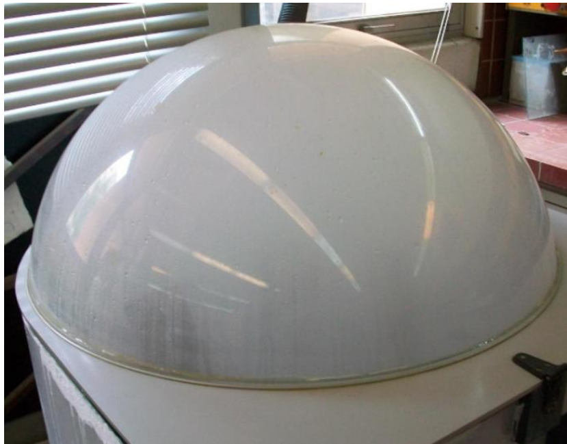
Εικόνα 8.2.3 Θάλαμος Αλατονέφωσης σε πλήρη λειτουργία.
