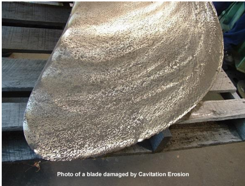
Εικόνα 2.2.4.1 Σπηλαιώδης διάβρωση σε έλικα πλοίου [7]
