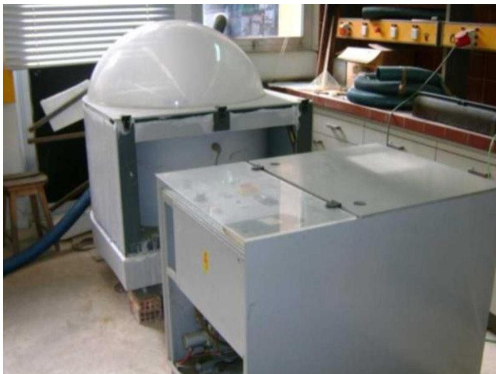
Εικόνα 8.2.1 Θάλαμος Αλατονέφωσης και Δεξαμενή Διαλύματος Αλατονέφωσης
