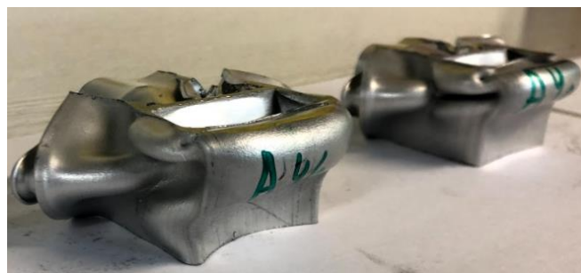
Εικόνα 3.14 Τελική άποψη δοκιμίου A4 κατά το πέρας της κατάρρευσης
