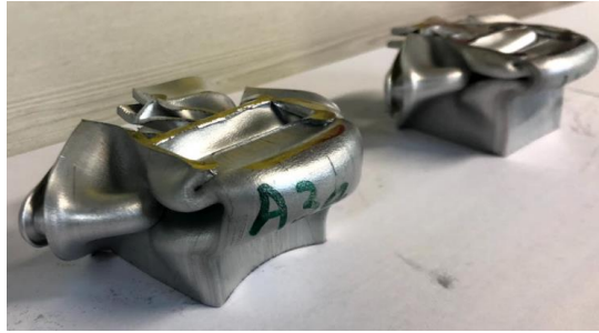
Εικόνα 3.21 Τελική άποψη δοκιμίου A3 κατά το πέρας της κατάρρευσης
