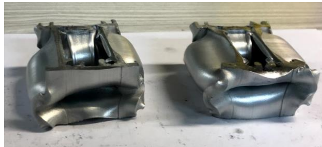
Εικόνα 3.32 Τελική άποψη δοκιμίου B5 κατά το πέρας της κατάρρευσης
