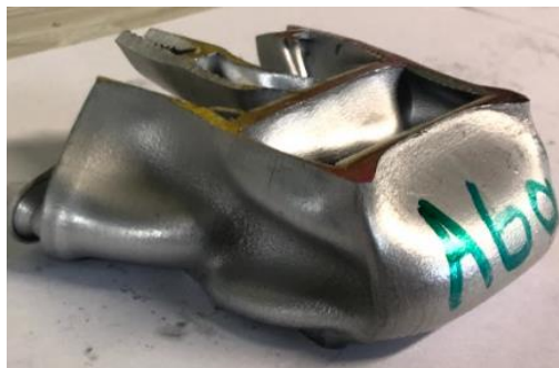
Εικόνα 3.23 Τελική άποψη δοκιμίου A6 κατά το πέρας της κατάρρευσης
