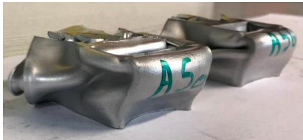
Εικόνα 3.22 Τελική άποψη δοκιμίου A5 κατά το πέρας της κατάρρευσης
