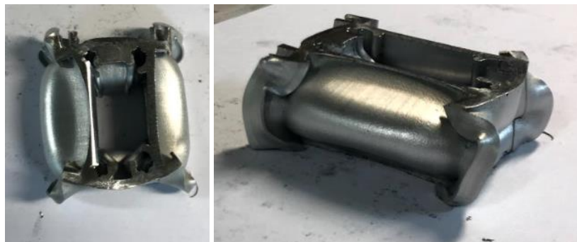
Εικόνα 3.41 Τελική άποψη δοκιμίου B6 κατά το πέρας της κατάρρευσης
