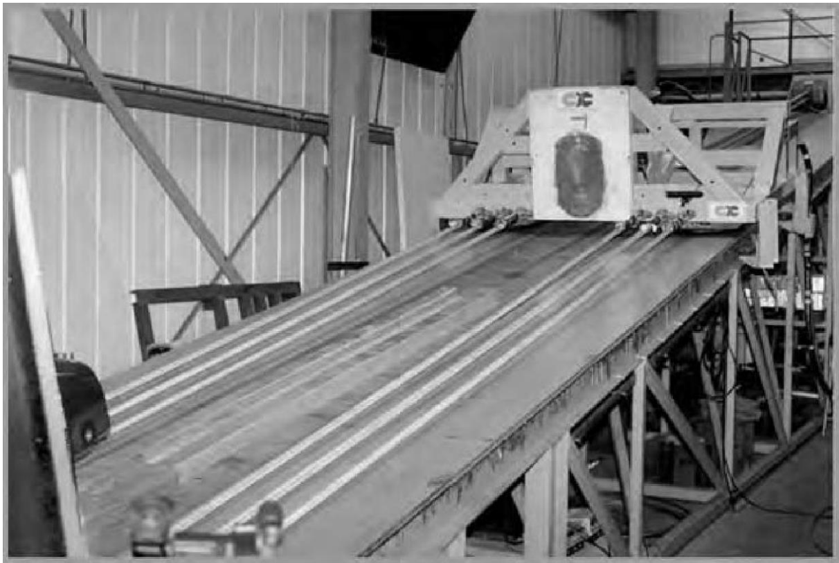
Εικόνα 2.12 Μηχανή δοκιμών Sled, που βρίσκεται στο κέντρο δοκιμών συγκρούσεων του Cranfield [81].
