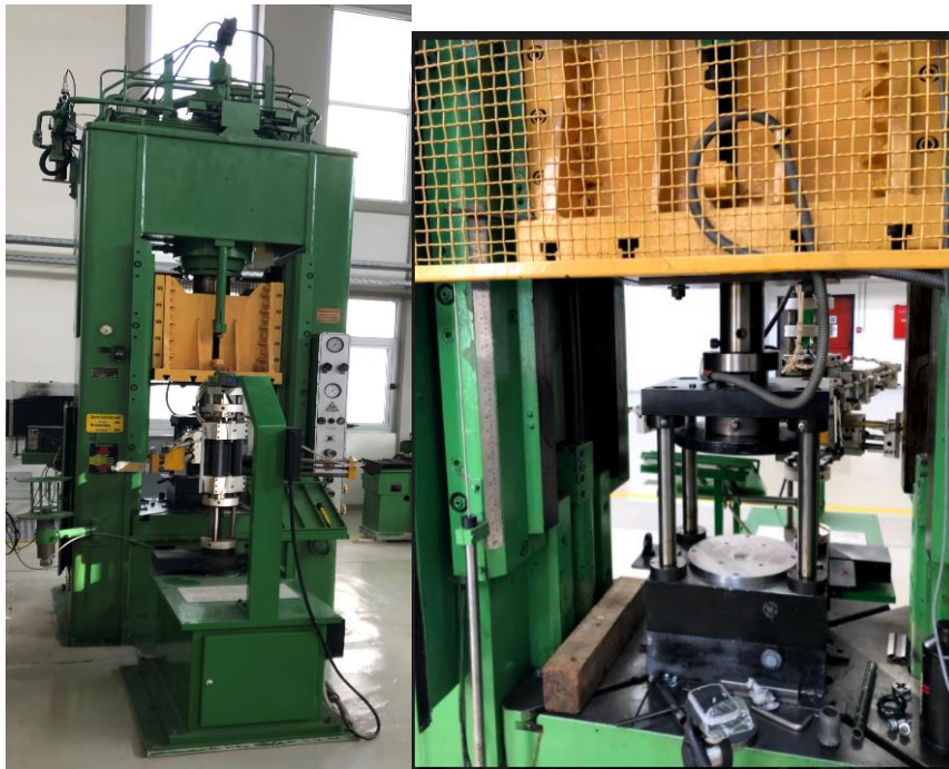
Εικόνα 3.1 Υδραυλική πρέσσα (γενική όψη και σημείο στήριξης δοκιμίων)
