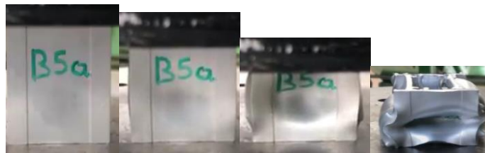
Εικόνα 3.29 Στιγμιότυπα κατάρρευσης δοκιμίου B5
