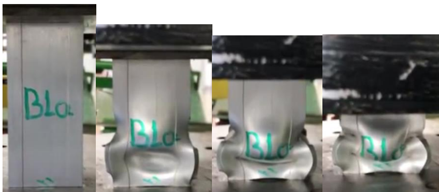
Εικόνα 3.36 Στιγμιότυπα κατάρρευσης δοκιμίου B1
