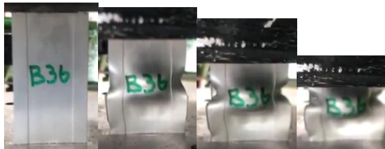
Εικόνα 3.28 Στιγμιότυπα κατάρρευσης δοκιμίου B3
