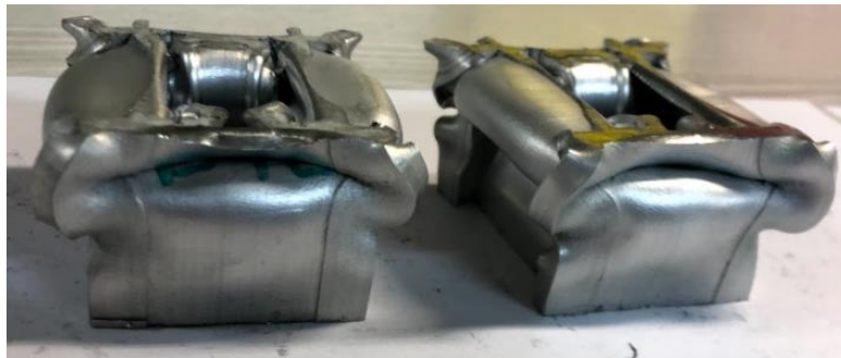
Εικόνα 3.40 Τελική άποψη δοκιμίου B4 κατά το πέρας της κατάρρευσης
