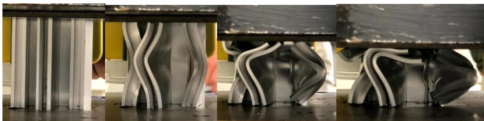
Εικόνα 3.19 Στιγμιότυπα κατάρρευσης δοκιμίου A5
