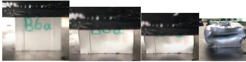
Εικόνα 3.38 Στιγμιότυπα κατάρρευσης δοκιμίου B6
