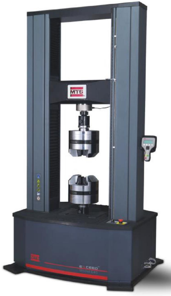
Εικόνα 2.10 Universal μηχανή δοκιμών της εταιρίας MTS [82].
