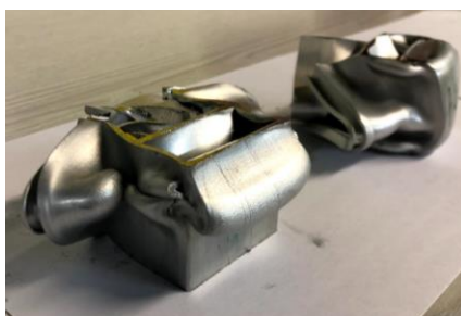
Εικόνα 3.13 Τελική άποψη δοκιμίου A2 κατά το πέρας της κατάρρευσης
