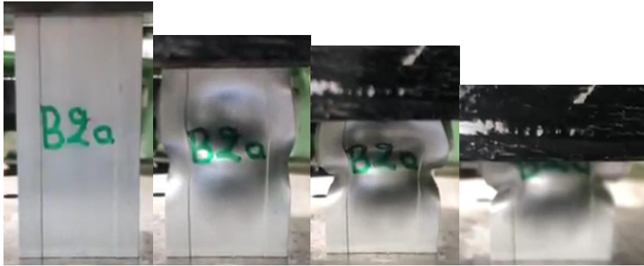
Εικόνα 3.27 Στιγμιότυπα κατάρρευσης δοκιμίου B2
