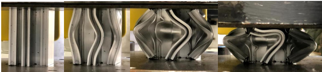
Εικόνα 3.11 Στιγμιότυπα κατάρρευσης δοκιμίου A4
