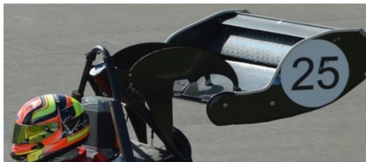
Εικόνα 4: Βάσεις πίσω πτέρυγας του μονοθεσίου P-17 της PROM RACING.
