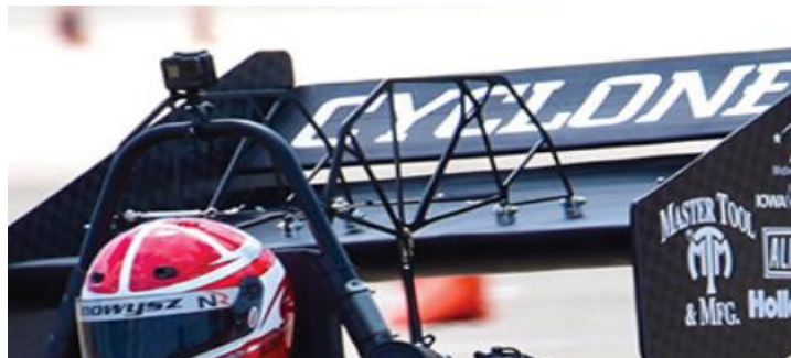
Εικόνα 3: Βάσεις πίσω πτέρυγας της ομάδας του πανεπιστημίου της Iowa.
