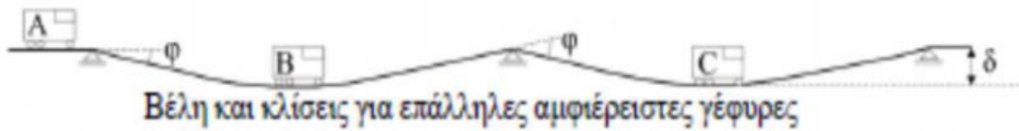
Σχήμα 6.14 : Βέλη και Στροφές Μεταξύ Γειτονικών Ανοιγμάτων
