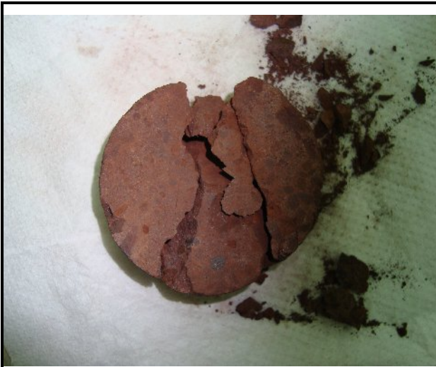
Εικόνα 34: Κάτοψη θραυσμένου δοκιμίου
