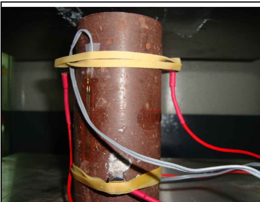
Εικόνα 19: Το δοκίμιο στη μηχανή φόρτισης, 4 αντιδιαμετρικοί αισθητήρες ΔΕ
