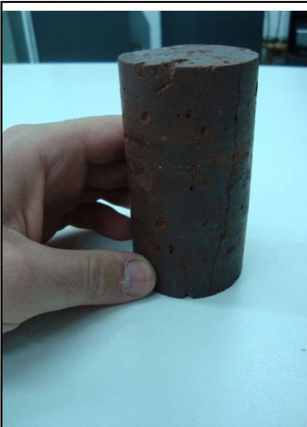
Εικόνα 24: Πλευρική άποψη δοκιμίου, διακρίνεται η κατακόρυφη ρωγμή που το διασχίζει.
