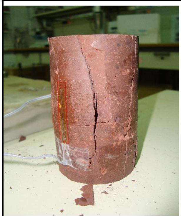
Εικόνα 28: Πλευρική άποψη, διακρίνεται η αποφλίωση κατά μήκος της επιφανειακής ρωγμής
