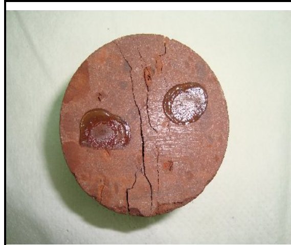
Εικόνα 43: Κάτοψη θραυσμένου δοκιμίου
