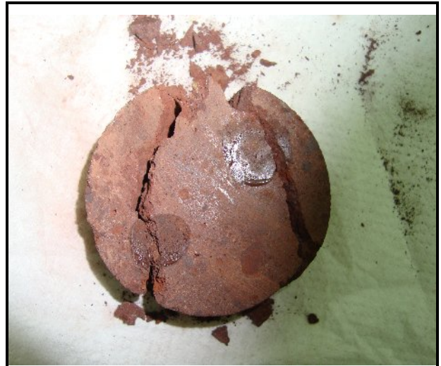
Εικόνα 35: Κάτοψη θραυσμένου δοκιμίου
