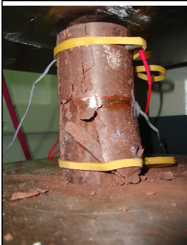
Εικόνα 20: Πλευρική άποψη θραυσμένου δοκιμίου
