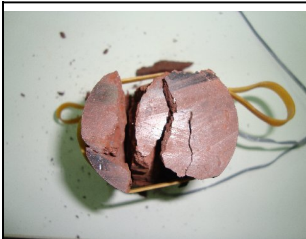
Εικόνα 22: Κατακόρυφη άποψη θραυσμένου δοκιμίου
