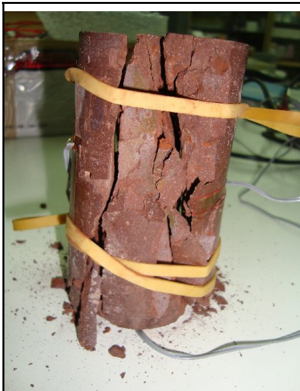
Εικόνα 21: Πλευρική άποψη θραυσμένου δοκιμίου
