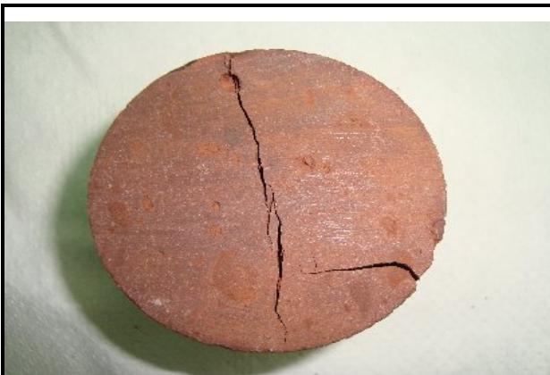
Εικόνα 44: Κάτοψη θραυσμένου δοκιμίου.
