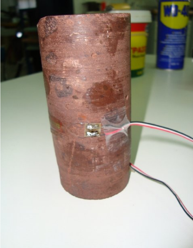
Εικόνα 11: Δοκίμιο και διαμετρικό μηχανοσκόπιο
