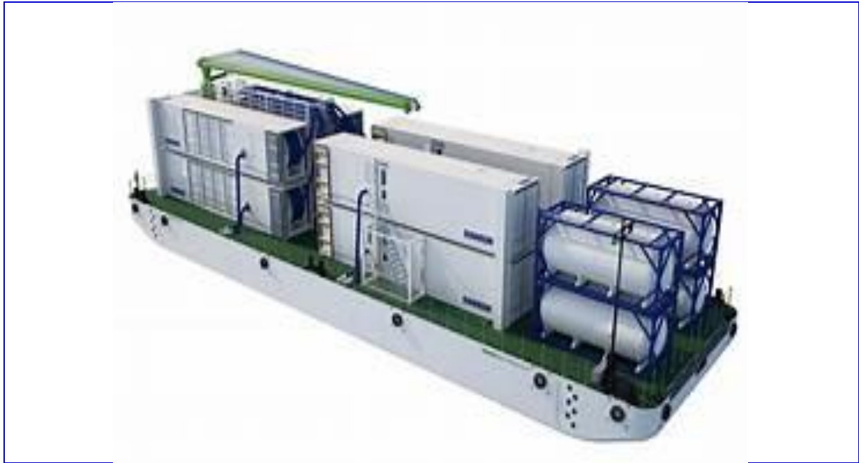
Εικόνα 4.1: Αποτύπωση εγκατάστασης Port Based Treatment
