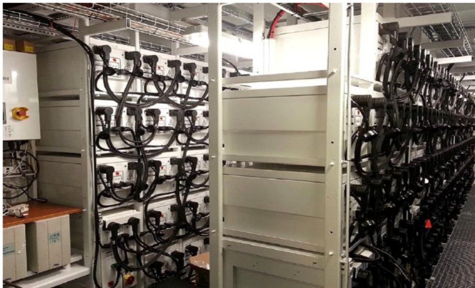
Εικόνα 13: Το πακέτο μπαταριών του πλοίου Ampere
