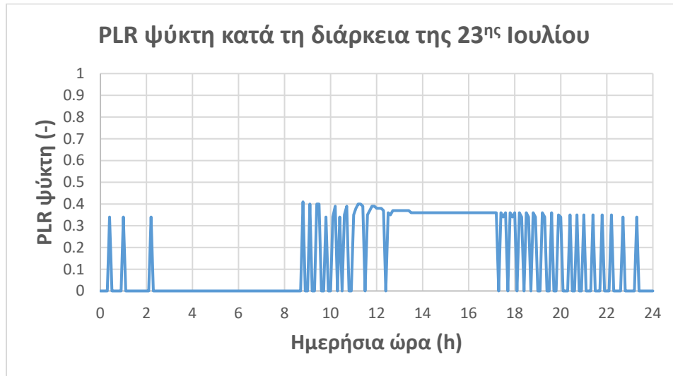
Σχήμα 121: PLR ψύκτη στις 23 Ιουλίου για την κατοικία των 200 m 2 στην Αθήνα και το σενάριο 1
