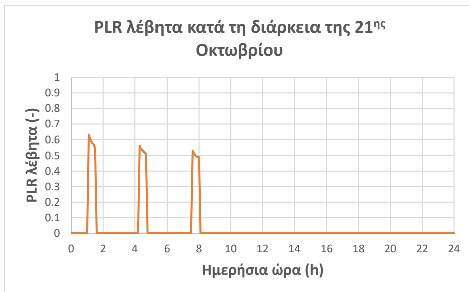
Σχήμα 99: PLR λέβητα στις 21 Οκτωβρίου για την κατοικία των 200 m 2 στη Νάξο και το σενάριο 1
