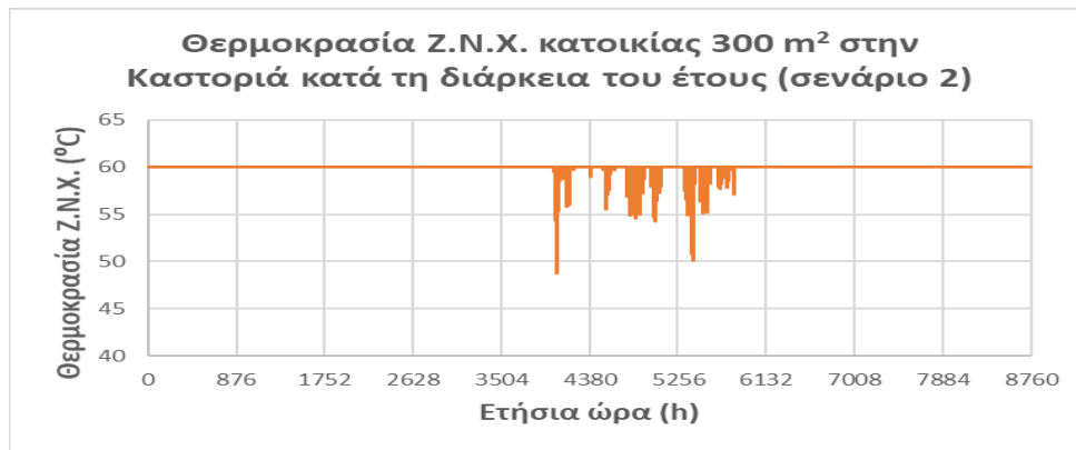
Σχήμα 194: Διακύμανση της θερμοκρασίας του Z.N.X. κατά τη διάρκεια του έτους για την κατοικία των 300 m 2 στην Καστοριά και το σενάριο 2
