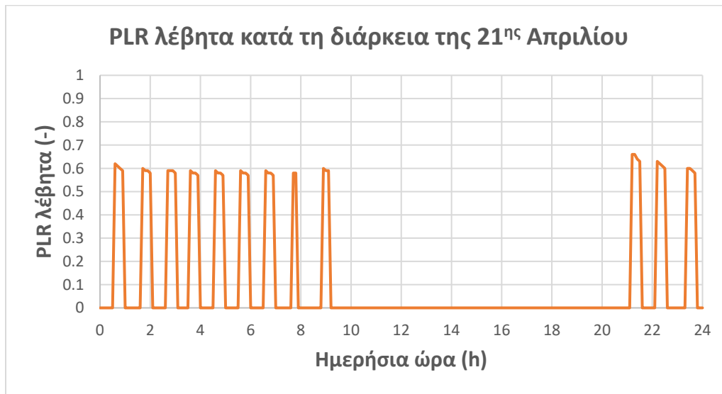
Σχήμα 85: PLR λέβητα στις 21 Απριλίου για την κατοικία των 200 m 2 στη Νάξο και το σενάριο 1
