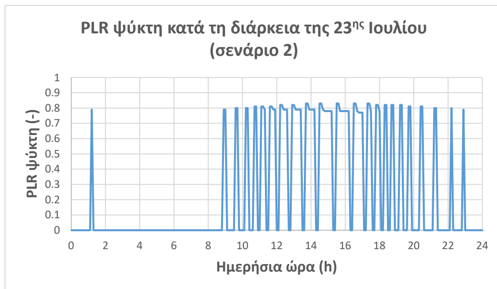
Σχήμα 122: PLR ψύκτη στις 23 Ιουλίου για την κατοικία των 200 m 2 στην Αθήνα και το σενάριο 2
