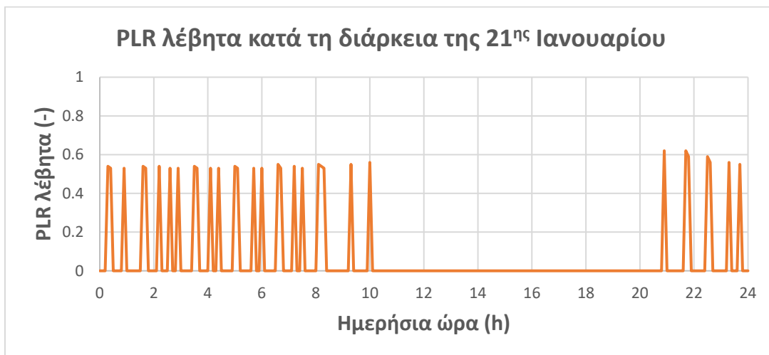
Σχήμα 140: PLR λέβητα στις 21 Ιανουαρίου για την κατοικία των 200 m 2 στην Καστοριά και το σενάριο 1
