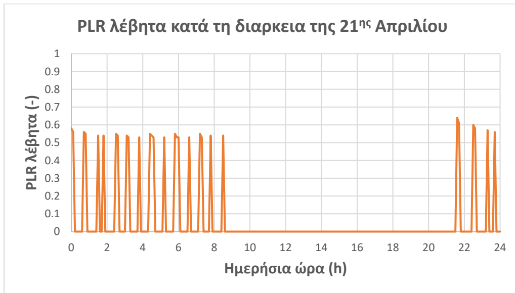
Σχήμα 142: PLR λέβητα στις 21 Απριλίου για την κατοικία των 200 m 2 στην Καστοριά και το σενάριο 1
