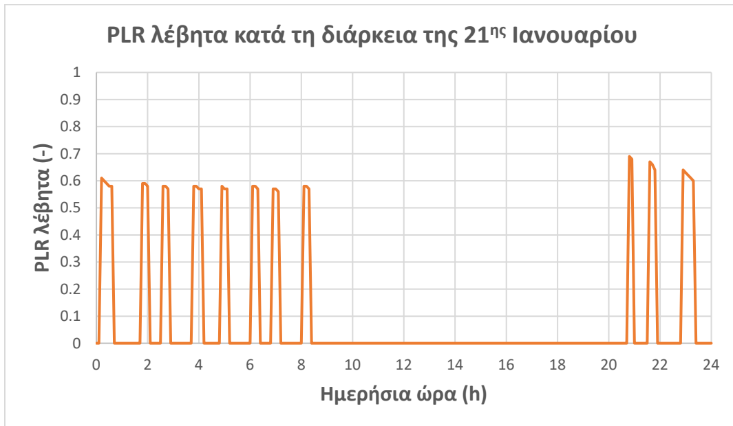
Σχήμα 80: PLR λέβητα στις 21 Ιανουαρίου για την κατοικία των 200 m 2 στη Νάξο και το σενάριο 1
