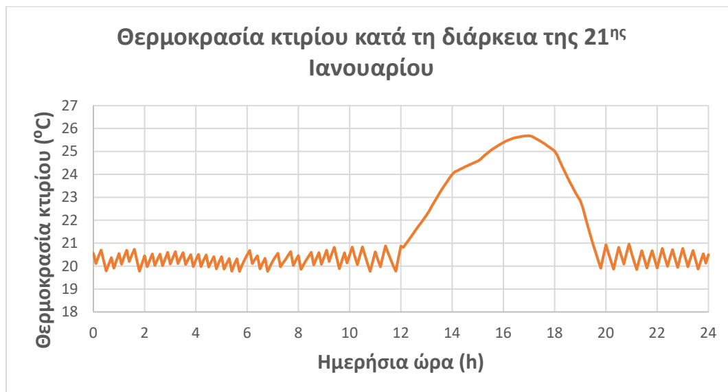
Σχήμα 116: Θερμοκρασία κτιρίου στις 21 Ιανουαρίου για την κατοικία των 200 m 2 στην Αθήνα και το σενάριο 1
