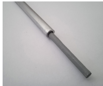
Ράβδος αλουμινίου 6mm και ξύλινο καλαμάκι 3,5mm για προσομοίωση της τηλεσκοπικής ράβδου
