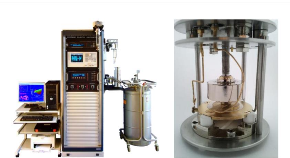
Εικόνα 2.3 Πειραματική Διάταξη DRS, αντίστοιχη με αυτή του εργαστηρίου διηλεκτρικής φασματοσκοπίας (αριστερά). Κυψελίδα μέτρησης (δεξιά)
