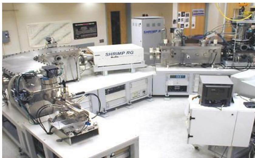
Εικόνα 6: Στην εικόνα φαίνεται ο Sensitive High Resolution Ion Micro Probe RG (SHRIMP RG) ένα όργανο υψηλής ακρίβειας που χρησιμοποιείται στην SIMS (www.speciation.net, 03/06/2021).
