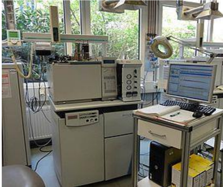
Εικόνα 8: Στην εικόνα έχουμε το όργανο που χρησιμοποιείται στον GC-IRMS (www.gfz-potsdam.de, 10/06/2021).
