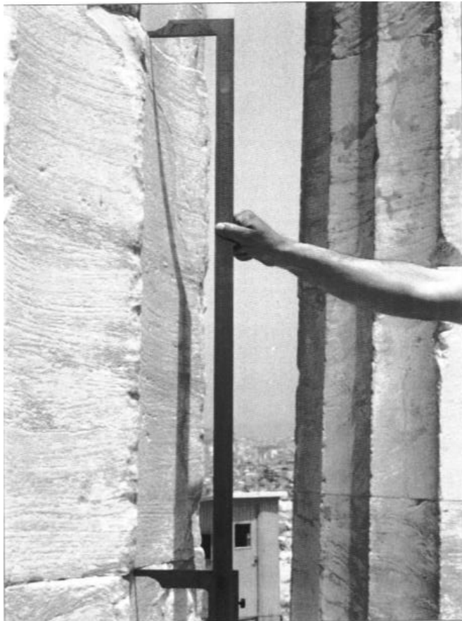
Εικόνα 89: Μέτρηση ύψους σπονδύλου (Μελέτη Δομικής Αποκαταστάσεως της Βόρειας Όψης του Παρθενώνος, Κ.Ζάμπας, ΥΠΠΟ, ΕΣΜΑ, Αθήνα 2002, σ. 39)
