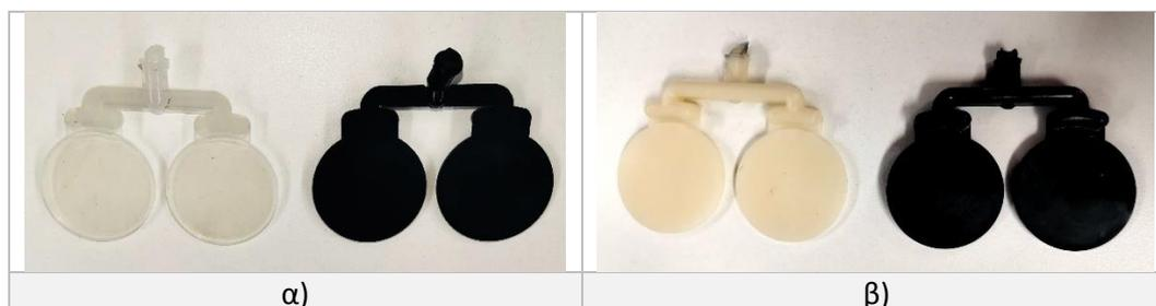
*Εικόνα 70: Κυκλικά δοκίμια παραγόμενα μέσω της διεργασίας έγχυσης σε καλούπι α) από rTPU και β) από rPA12.*
