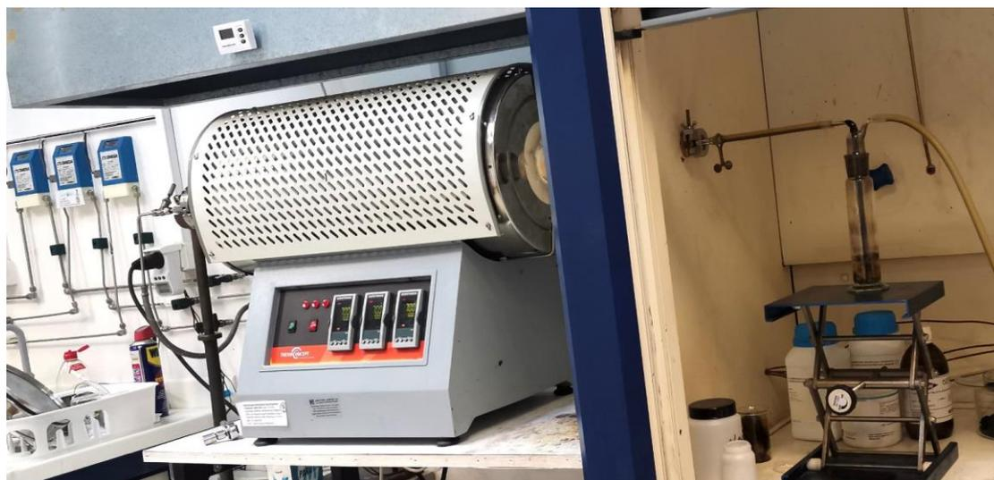
Εικόνα 23: Πειραματική διάταξη του αντιδραστήρα της μεθόδου CVD.
