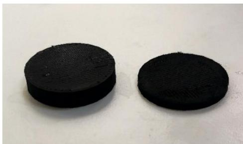
*Εικόνα 68: Από αριστερά το εκτυπωμένο δοκίμιο πριν και από δεξιά μετά την λείανση.*
