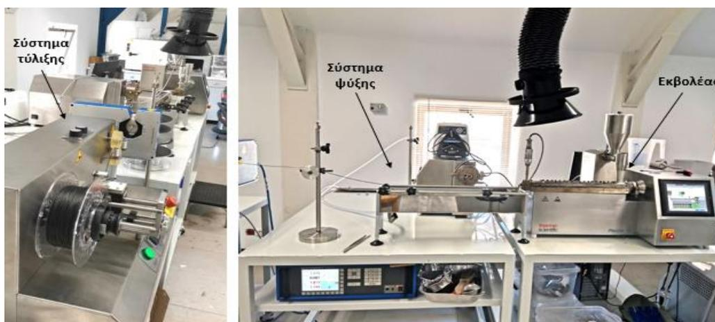
*Εικόνα 62: Πειραματική διάταξη συστήματος εκβολής.*
