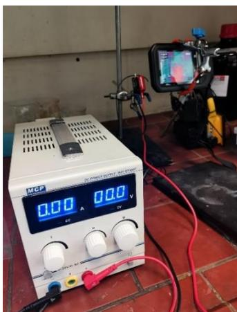
Εικόνα 75: Πειραματική διάταξη εξέτασης ιδιότητας αυτό-ίασης σε νήματα.
