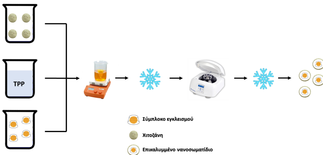
Σχήμα 6. Πειραματική διαδικασία παραγωγής επικαλυμμένων νανοσωματιδίων μέσω ιονοτροπικής πηκτωμάτωσης
