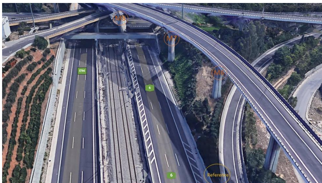
Σχήμα 5-4: Θέσεις ψηφιακών κλισιμέτρων στις στέψεις των πυλώνων M6, M7, M8 και του κλισιμέτρου αναφοράς
