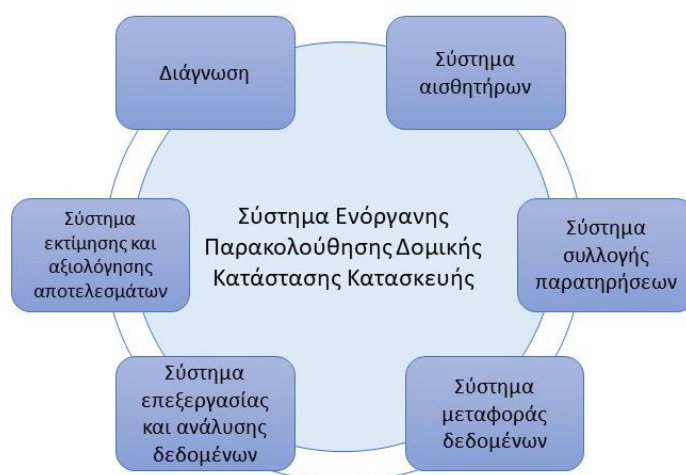
Σχήμα 5-3: Στοιχεία συστήματος ΠΔΚ Figure 5-3: SHM components
