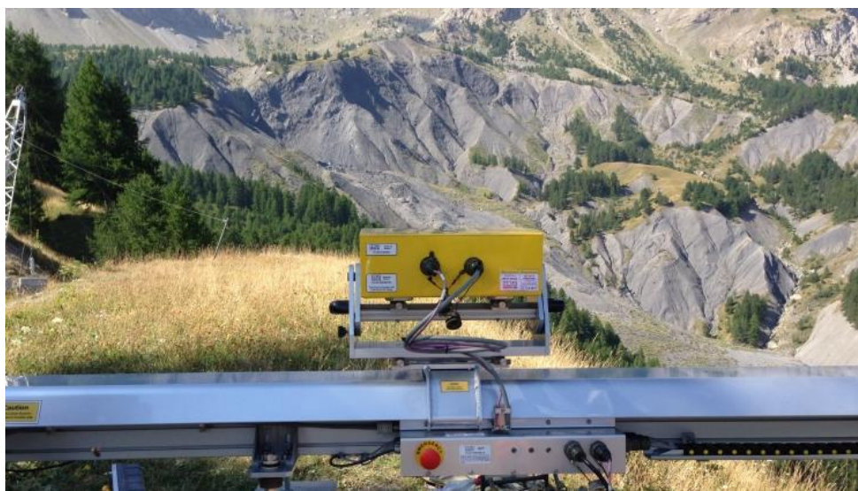
Σχήμα 2-4: Απεικόνιση IBIS-S για την παρακολούθηση μετακινήσεων και παραμορφώσεων Figure 2-4: View of IBIS-S for monitoring movements and displacements (Πηγή: www.idsgeoradar.com )
