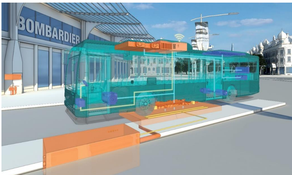
Σχήμα 23: Επαγωγική φόρτιση ηλεκτρικού λεωφορείου – 2 ( https://automotive-exports.com/ )
