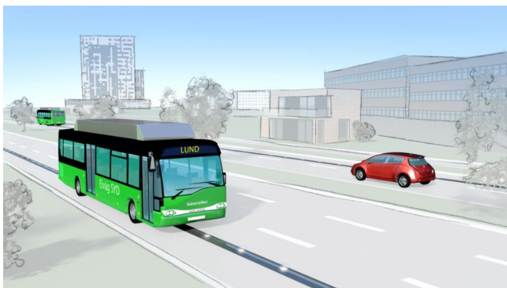
Σχήμα 22: Επαγωγική φόρτιση ηλεκτρικού λεωφορείου – 1 ( https://www.urban-transport-magazine.com/ )
