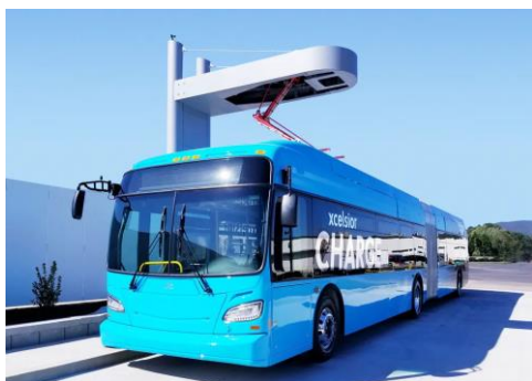
Σχήμα 5: Ηλεκτρικό λεωφορείο κατά την φόρτιση (1)
