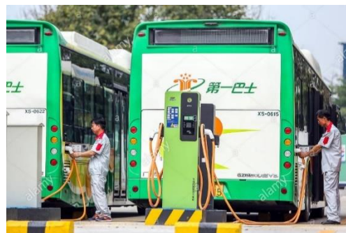
Σχήμα 6: Ηλεκτρικό λεωφορείο κατά την φόρτιση (2)
