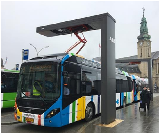
Σχήμα 19: Αγωγή φόρτιση BEB με παντογράφο – 2 (https://www.linkedin.com/pulse/sustainable-public-transport/)
