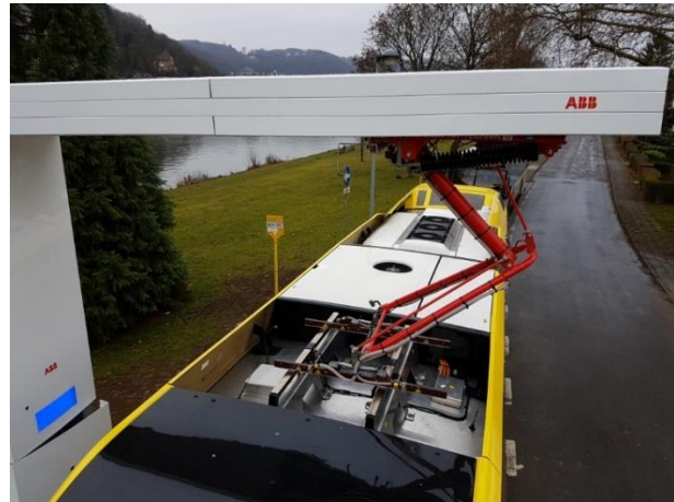
Σχήμα 20: Αγωγή φόρτιση BEB με παντογράφο – 3 (https://www.sustainable-bus.com/)
