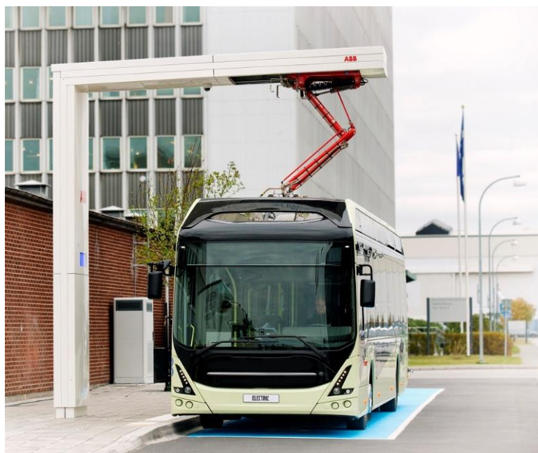
Σχήμα 18: Αγώγιμη φόρτιση ηλεκτρικού λεωφορείου με παντογράφο – 1 ( https://new.abb.com/ )
