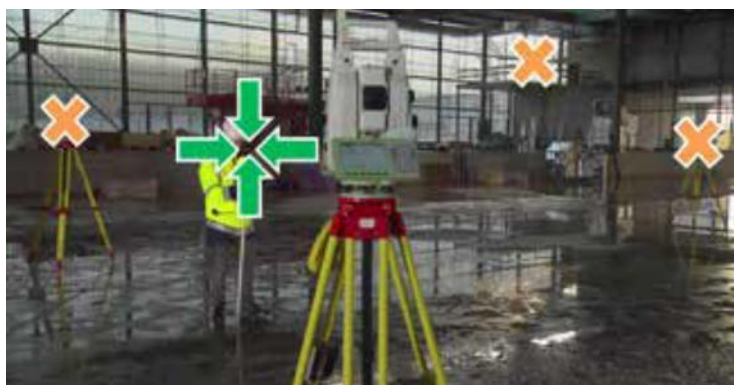
Εικόνα A.11: Η εφαρμογή φίλτρου PowerSearch για να αγνοηθούν μη σχετικοί στόχοι [Leica Geosystems AG, 2017]
