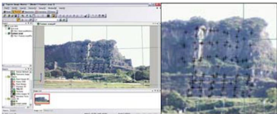
Εικόνα Α.2: Εφαρμογή της μεθόδου «Feature Scan» [Topcon Co, 2011]
