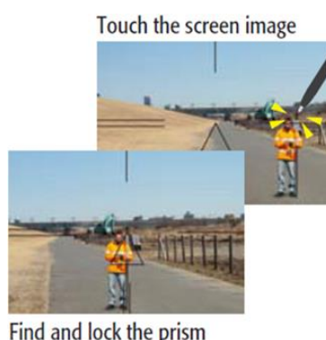
Εικόνα Α.6: Η τεχνολογία «Touch Drive» του σταθμού Topcon IS-3 [Topcon Co., 2011]
