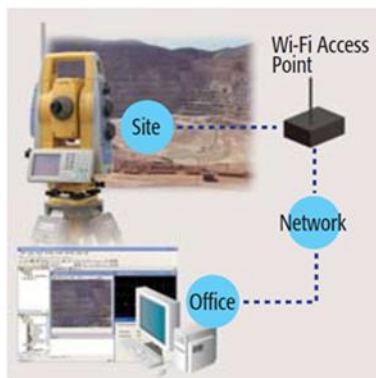
Εικόνα Α.7: Έλεγχος των εικόνων και των σαρώσεων του IS μέσω WLAN σύνδεσης [Topcon Co., 2011]
