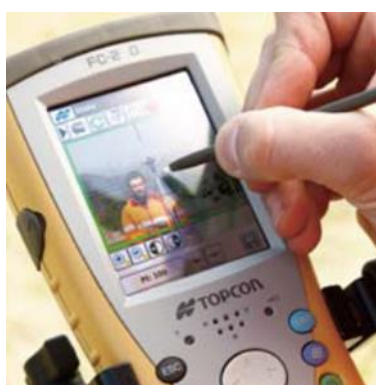
Εικόνα A.4: Λειτουργία μεταφοράς video σε πραγματικό χρόνο από τον σταθμό IS στο χειριστήριο συλλογής δεδομένων (data collector) [Topcon Co, 2011]
