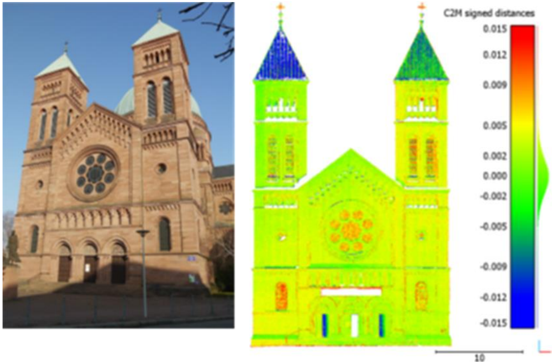
Εικόνα 1.1: Η αποτύπωση με τον σταθμό Trimble SX10 της εκκλησίας "Saint-Pierre-le-Jeune" [Lachat E., et al, 2017A]
