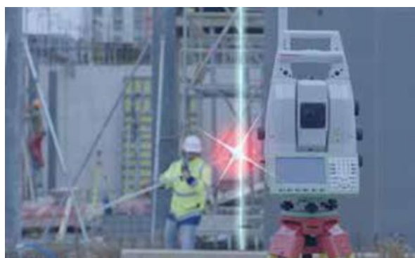
Εικόνα A.12: Η τεχνολογία CubeSearch σε έναν κινούμενο στόχο [Leica Geosystems AG, 2017]
