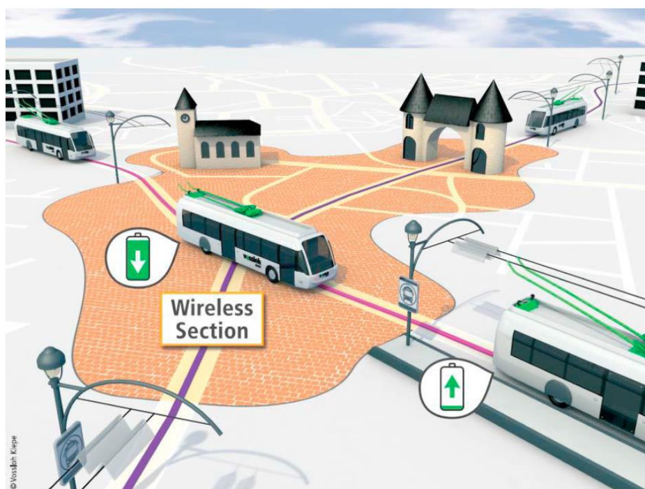
Σχήμα 1: Η ιδέα του συστήματος φόρτισης εν κινήσει IMC [Vossloh Kiepe] [Bartłomiejczyk (2017)]
