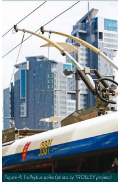
Σχήμα 8: Οι πόλοι του τρόλεϊ με μπαταρία [TROLLEY project - UITP]
