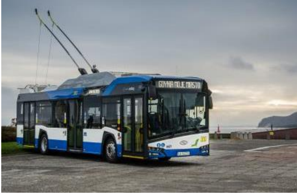
Σχήμα 4: Το νέας τεχνολογίας τρόλεϊ με μπαταρία (BAT) [trolley:motion, E-Bus-Systems]
