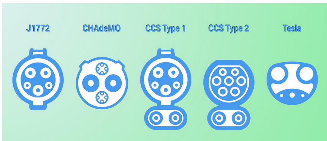
Εικόνα 2.3. – Βασικοί τύποι βυσμάτων φόρτισης ηλεκτρικών οχημάτων σύμφωνα με τα ισχύοντα πρότυπα
