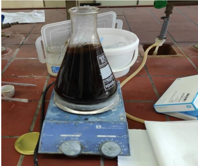
Εικόνα 12. Εναιώρημα SCG υπό ανάδευση
