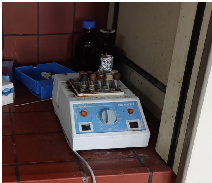
Εικόνα 8. Αντιδραστήρας COD της HACH δυνατότητας ταυτόχρονης χώνευσης 24 δειγμάτων.
