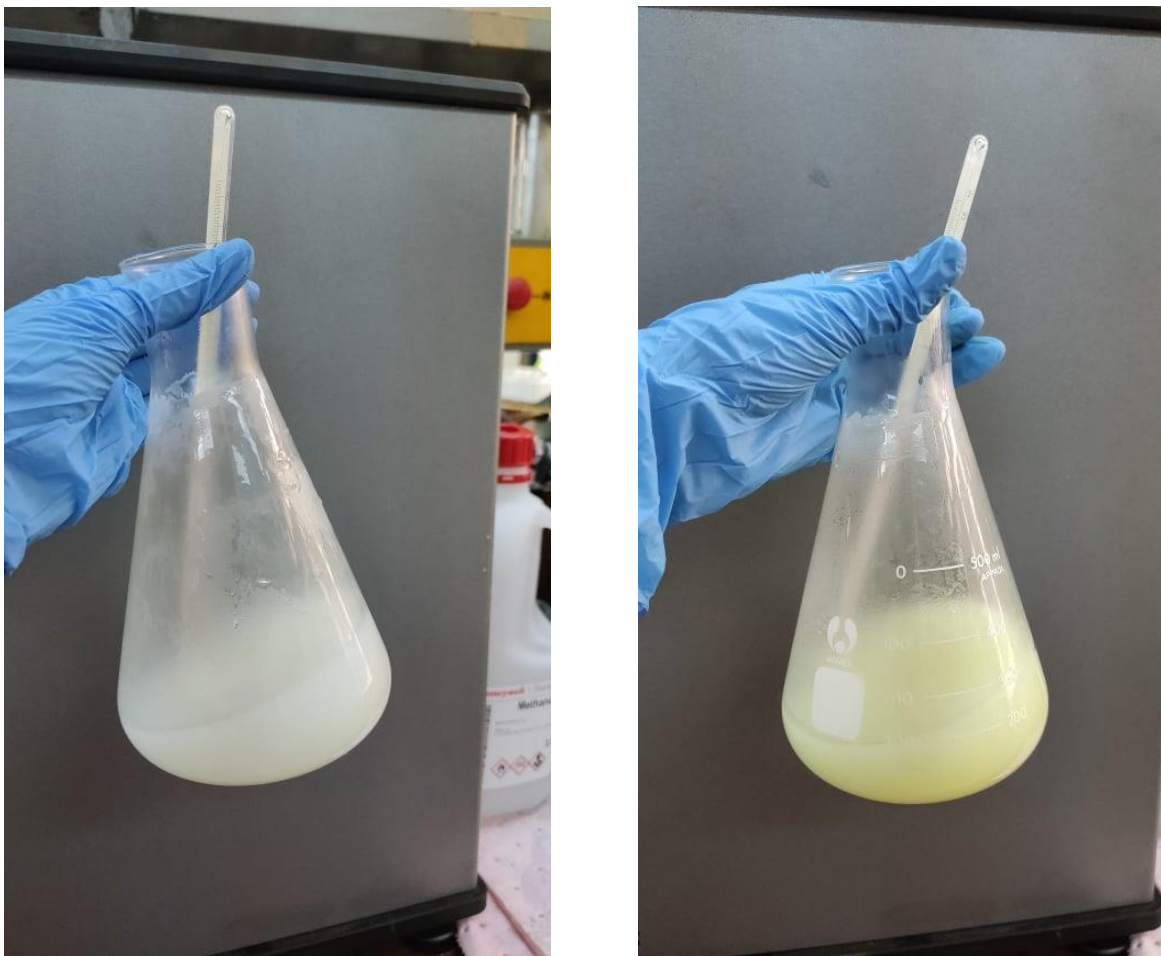
Εικόνα 18: Παγωμένο δείγμα (κρυστάλλωση) πριν την διήθηση. Αριστερά το ελαφρύ δείγμα UCO (400-450 °C) και δεξιά το βαρύ δείγμα UCO (450-500 °C).
