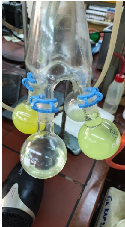
Εικόνα 15: Σφαιρική φιάλη No1 (μπροστά) γεμάτη με το απορριπτόμενο κλάσμα <math><400\text{ }^\circ\text{C}</math>, σφαιρική φιάλη No2 (δεξιά) γεμάτη με το ελαφρύτερο κλάσμα 400-450 °C και σφαιρική φιάλη No4 (αριστερά) γεμάτη με το βαρύτερο κλάσμα 450-500 °C.
