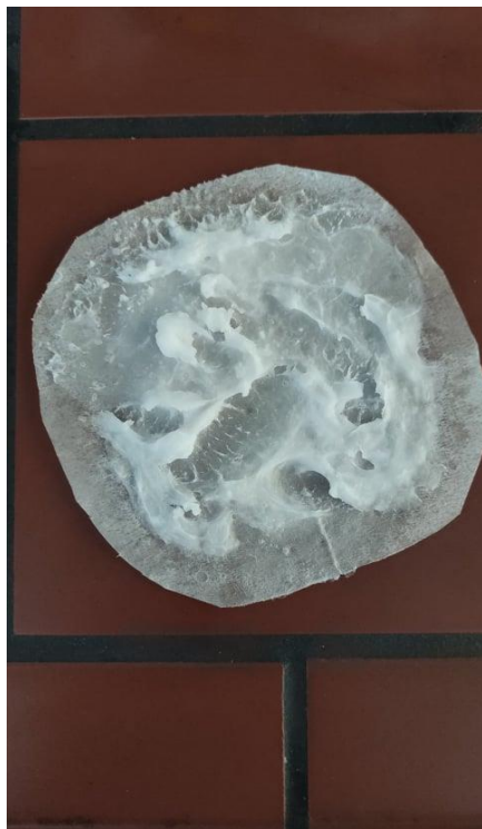
Εικόνα 20: Παραφίνες που προέκυψαν μετά το πέρας της διήθησης. Αριστερά το ελαφρύ δείγμα UCO (400-450 °C) και δεξιά το βαρύ δείγμα UCO (450-500 °C).
