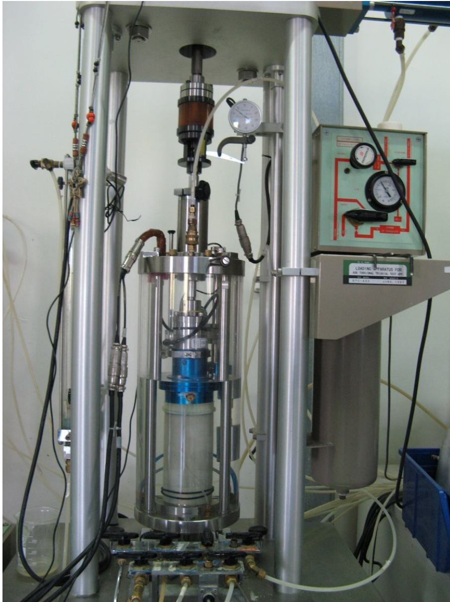
Σχήμα Α3. Τριαξονική κυψέλη (διακρίνεται στο κέντρο της συσκευής). Δεξιά πάνω βρίσκεται το σύστημα τροφοδότησης για την επιβολή στρεπτικού φορτίου και από κάτω η δεξαμενή εκτόνωσης
