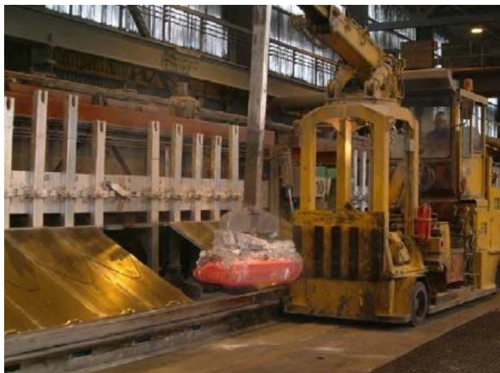
Εικόνα 4.4 Αλλαγή ανόδου σε κελί ηλεκτρόλυσης και υπολειπόμενο τμήμα της ανόδου που αποσύρεται από το κελί (Iffert M. 2007)
