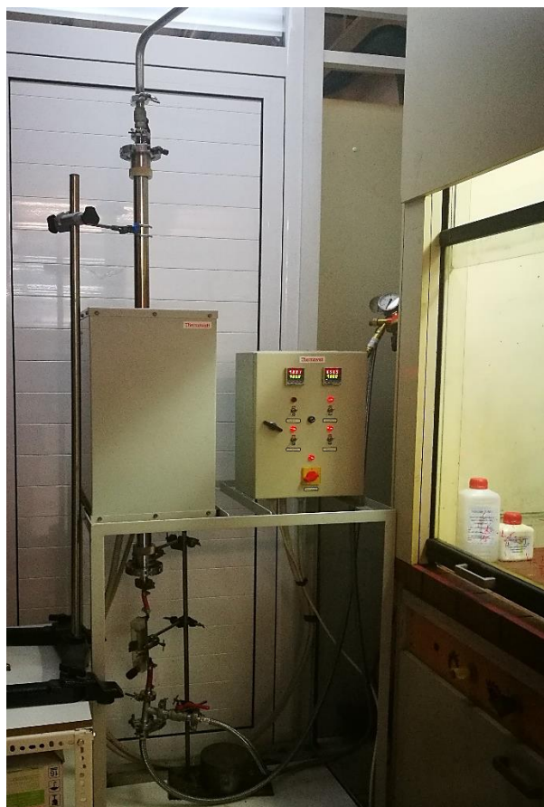
Εικόνα 20: Κατακόρυφο σύστημα TC-CVD εν ώρα λειτουργίας.
