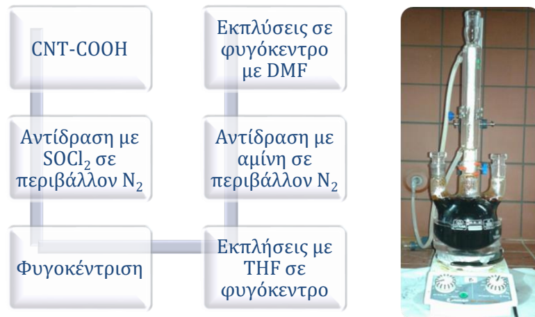
Σχήμα 39: Πειραματική διαδικασία χημικής τροποποίησης MWCNTs με αμινομάδες.
