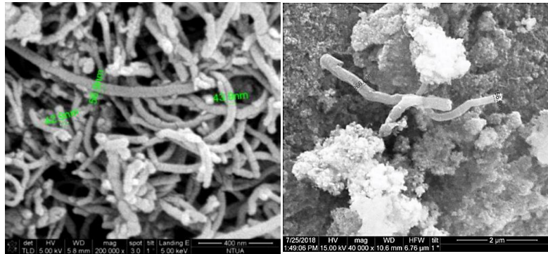
Εικόνα 21: MWCNTs από οριζόντιο TC-CVD (αριστερά), CNFs από κατακόρυφο TC-CVD (δεξιά). Υπόστρωμα καταλύτη: Πυριτική παιπάλη.
