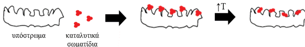
Εικόνα 14. «Αλληλεπιδράσεις» μεταξύ υποστρώματος και καταλυτικών σωματιδίων
